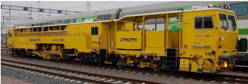
Kuva 5.23. Tukemiskone Plasser & Theurer 09-32 CSM (Ttk1 836) Ilmalan rata-pihalla vuonna 2010. Työskentelysuunta kuvassa vasemmalle. Muokattu lähteestä [77]
