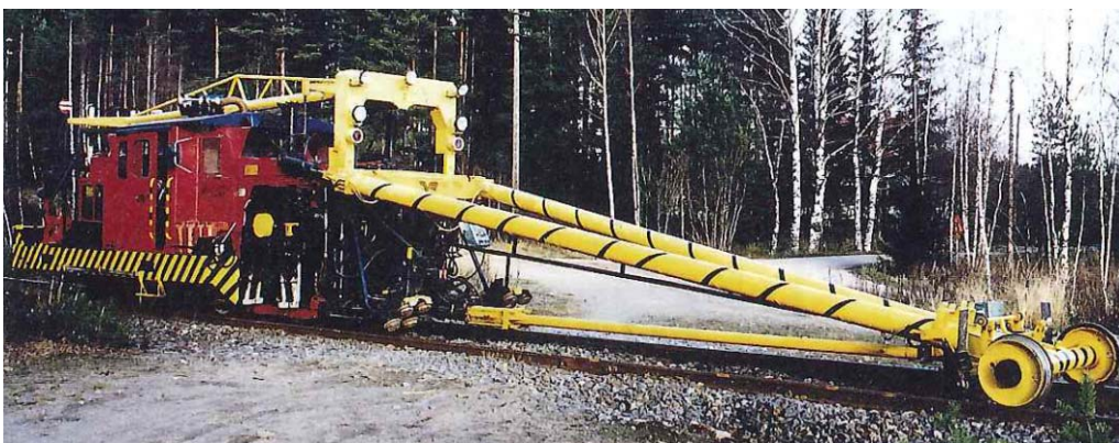
Kuva 5.16. Tukemiskone Matisa BNRI-85 (Ttk1 812) ulokevarsivaaituslaitteineen. [21]
