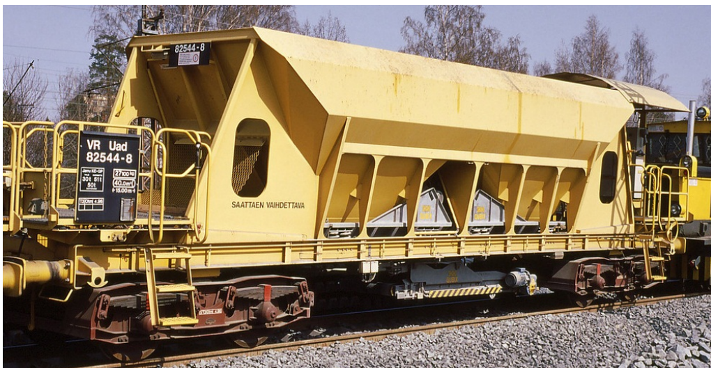
Kuva 5.53. Uad-sepelöntivaunu Pitäjänmäellä vuonna 2000. Vaunun alta kääntyvä hihnakuuljetin näkyvissä vaunun keskellä. Muokattu lähteestä [101]
