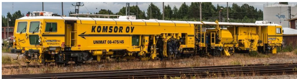
Kuva 5.38. Nykyaikainen Plasser & Theurer 08-475/4S vaihteentukemiskone Joensuussa vuonna 2013. Muokattu lähteestä [88]
