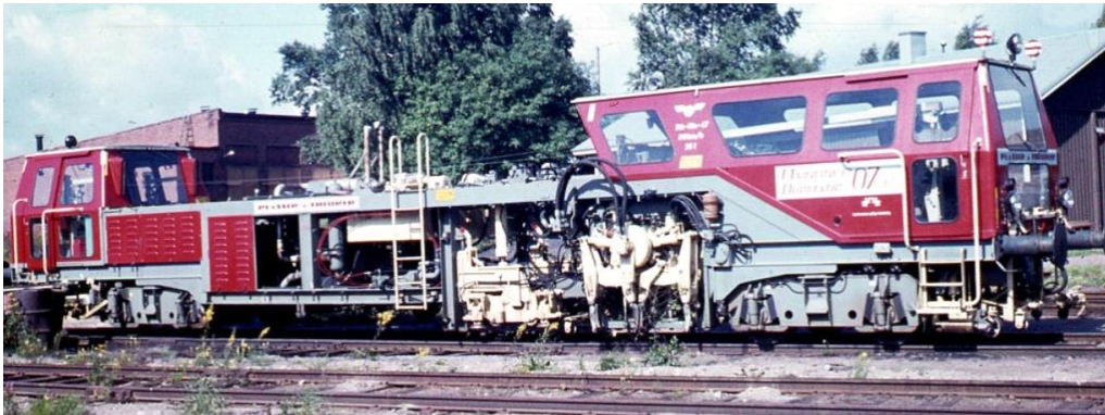
Kuva 5.16. Tukemiskone Plasser & Theurer MD 07-32 Kotkassa vuonna 1974. Kirjaimet MD tulevat sanoista Mainliner-Duomatic. Muokattu lähteestä [33]
