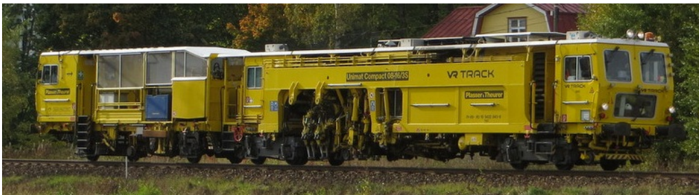
Kuva 5.40. Plasser & Theurer Unimat Compact 08-16/3S vaihteentukemiskone. Muokattu lähteestä [91]
