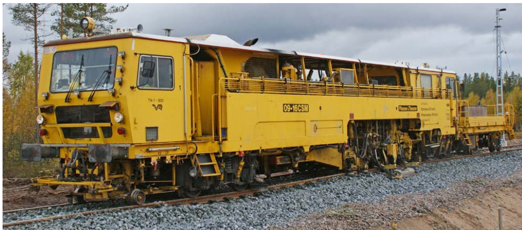
Kuva 5.21. Tukemiskone Plasser & Theurer 09-16 CSM (Ttk1 830) liikennepaikkavälillä Murtomäki–Talvivaara syksyllä 2008. Muokattu lähteestä [36]
