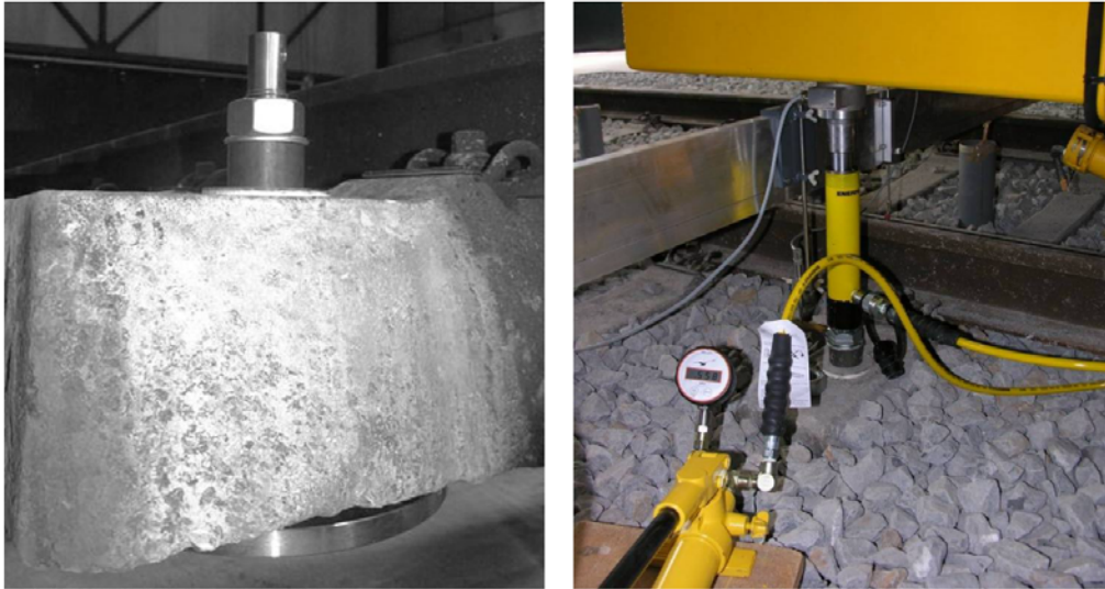
Kuva 3.23. Ratapölkyn pään alla tehtävän levykuormituskokeen koejärjestelyt. [48]
