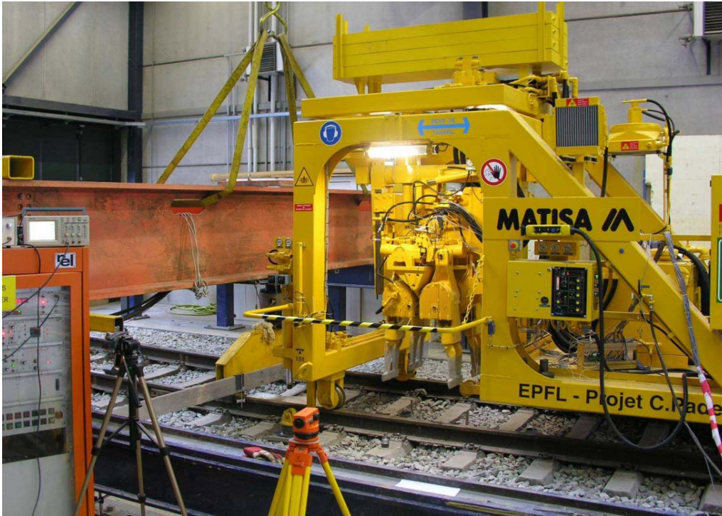
Kuva 3.22. Koejärjestelyissä käytetty tukemisyksikkö ja liikennekuormitus-simulaatioissa käytetty kuormitusjärjestely (vasemmalla). [47]
