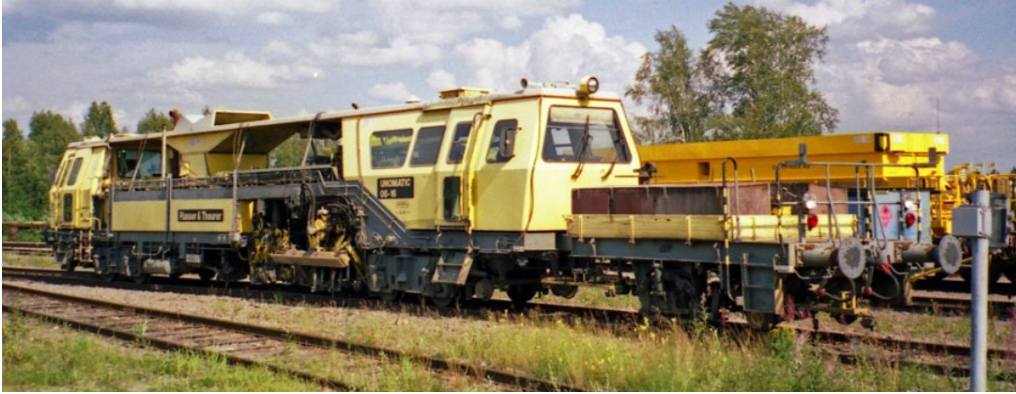
Kuva 5.19. Tukemiskone Plasser & Theurer 08-16 Unomatic Ylivieskassa vuonna 2003. Muokattu lähteestä [74]
