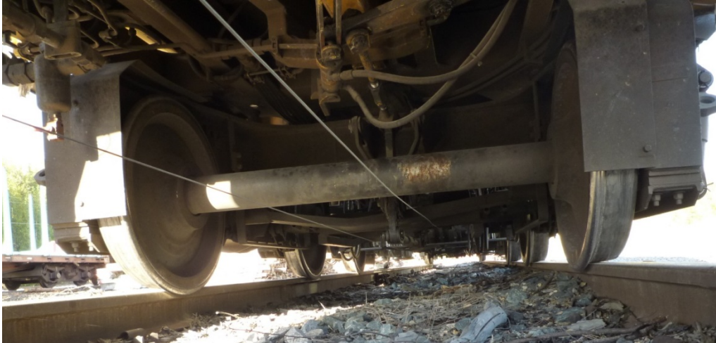
Kuva 5.9. Tukemiskoneen P&T 09-32 CSM sivuttaissiirron mittalangat koneen neljänneksen mittapyörästä etupuolelta koneen keulaa kohti kuvattuna.
