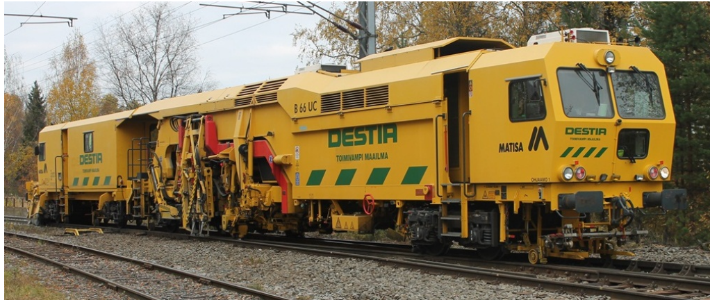
Kuva 5.41. Matisa B 66 UC vaihteentukemiskone Suomenjoella syksyllä 2014. Muokattu lähteestä [92]
