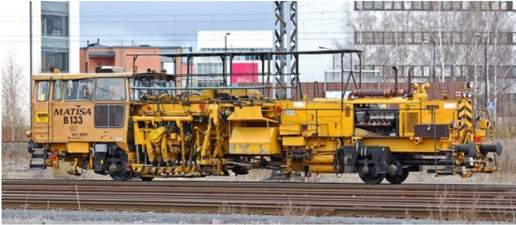
Kuva 5.35. Tukemiskone Matisa B133 (Ttk2 91051) siirtoajokunnossa Oulun tavararata-alueella vuonna 2007. Työskentelysuunta kuvassa vasemmalle. Muokattu lähteestä [29]
