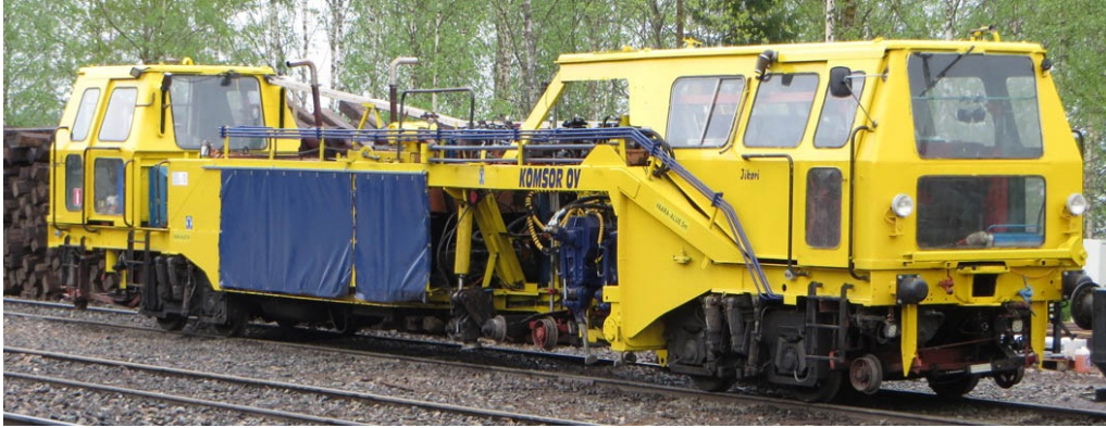
Kuva 5.39. Plasser & Theurer VPRS-500 vaihteentukemiskone Paltamossa vuonna 2014. Muokattu lähteestä [89]
