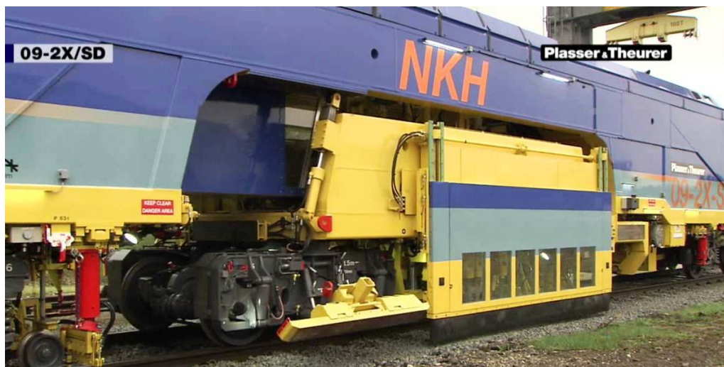
Kuva 5.29. Havainnekuva Plasser & Theurer 09-2X/SD tukemiskoneen tukemisyksikön pöly- ja melusuojauskoteloinnista. Muokattu lähteestä [85]
