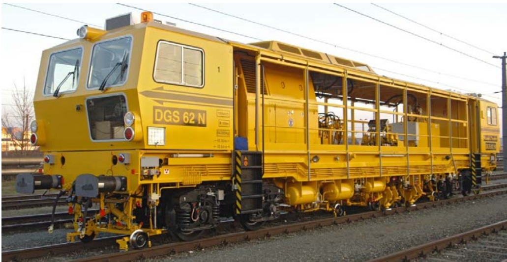
Kuva 5.50. Plasser & Theurer DGS 62 N stabilisaattori. Muokattu lähteestä [98]
