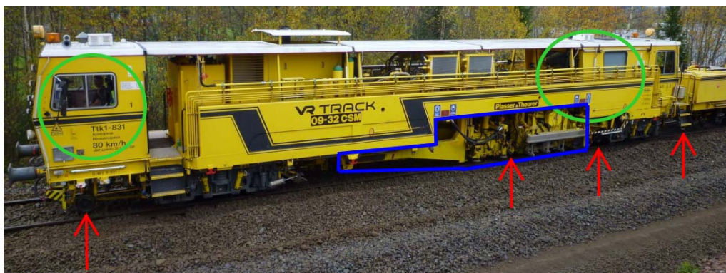
Kuva 5.1. Yleiskuva Plasser & Theurerin 09-32 CSM tukemiskoneesta ja sen keskeisimmistä osista. Koneen työskentelysuunta kuvassa vasemmalle.
