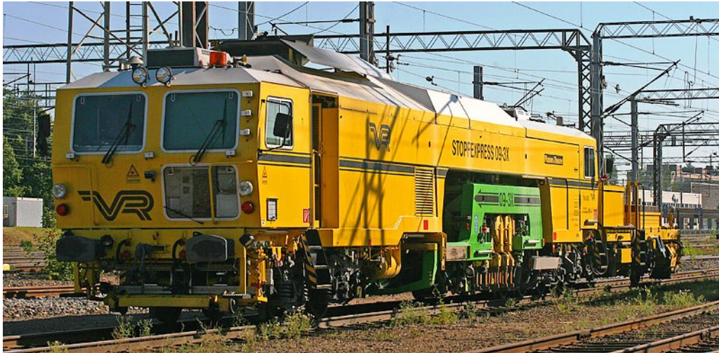
Kuva 5.24. Tukemiskone Plasser & Theurer Dynamic Tamping Express 09-3X (Ttk1 833) Kouvolan liikennepaikalla vuonna 2007. Muokattu lähteestä [38]
