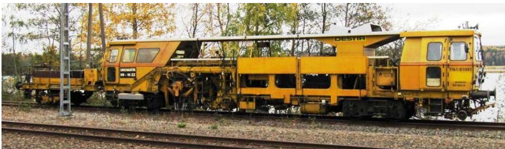
Kuva 5.26. Tukemiskone Plasser & Theurer Unomatik 08-16 ZZ Siurossa vuonna 2011. Muokattu lähteestä [80]
