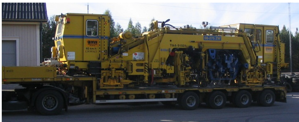
Kuva 5.43. Vaihteentukemiskone 08-275 ZW siirtokunnossa lavetilla. Muokattu lähteestä [94]
