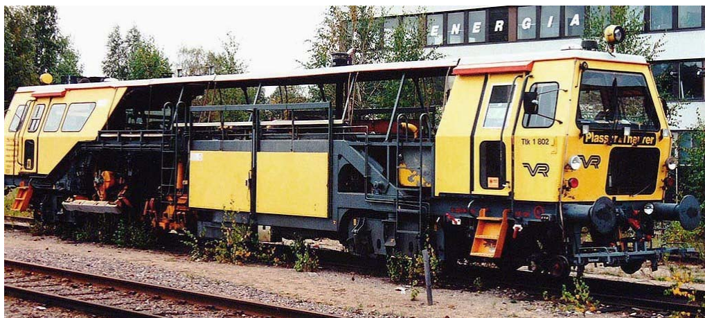
Kuva 5.18. Tukemiskone Plasser & Theurer 07-16 Universal Lahden liikennepaikal- la vuonna 1998. Muokattu lähteestä [35]
