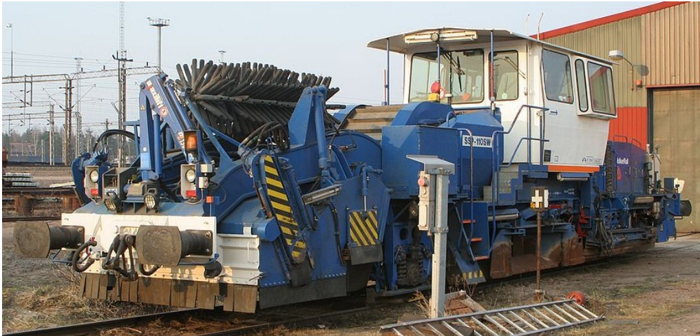
Kuva 5.54. Destia Rail Oy:n sepeliäura Plasser & Theurer SSP 110 SW (Tsl 91021) Kouvolassa vuonna 2006. Koneen työskentelysuunta kuvassa oikealle. Muokattu lähteestä [102]
