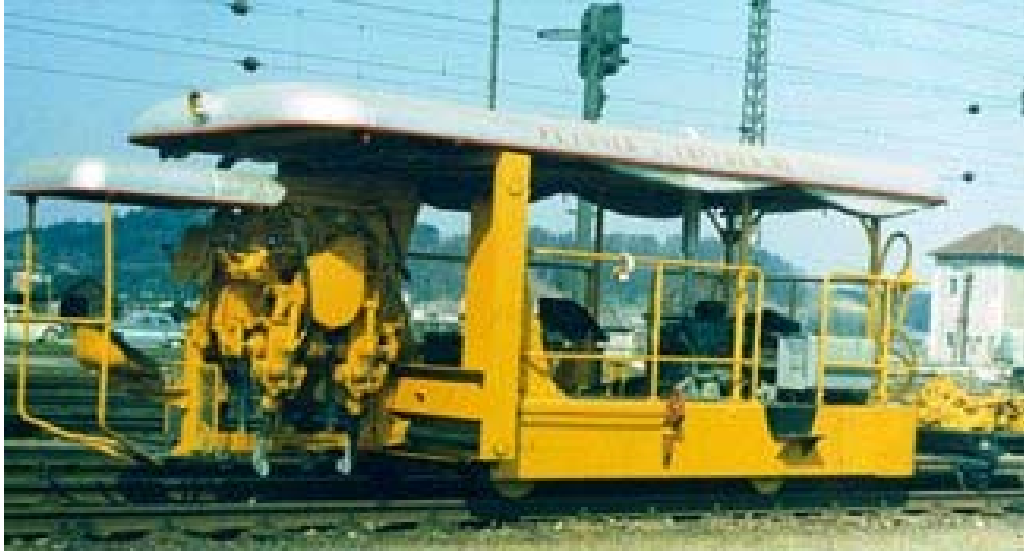
Kuva 5.33. Maailman ensimmäinen vaihteentukemiskonemalli Plasser & Theurer WE75. Muokattu lähteestä [20]
