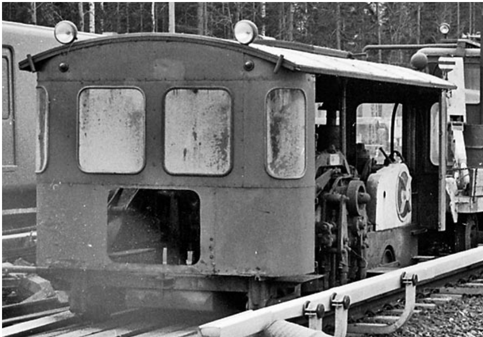
Kuva 5.13. Maailman ensimmäinen tukemiskonetyyppi Matisa Standard. [24]
