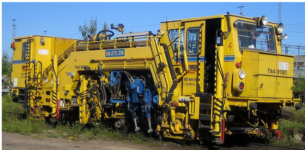
Kuva 5.42. Plasser & Theurer 08-275 ZW vaihteentukemiskone Kouvolassa vuonna 2007. Muokattu lähteestä [93]
