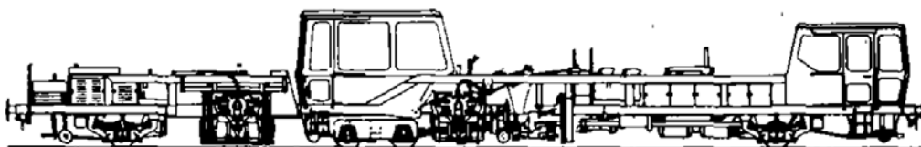
Kuva 5.17. Havainnekuva neljän ratapölkyn tukemiskoneesta Plasser & Theurer 08-Quatromatic. [22].
