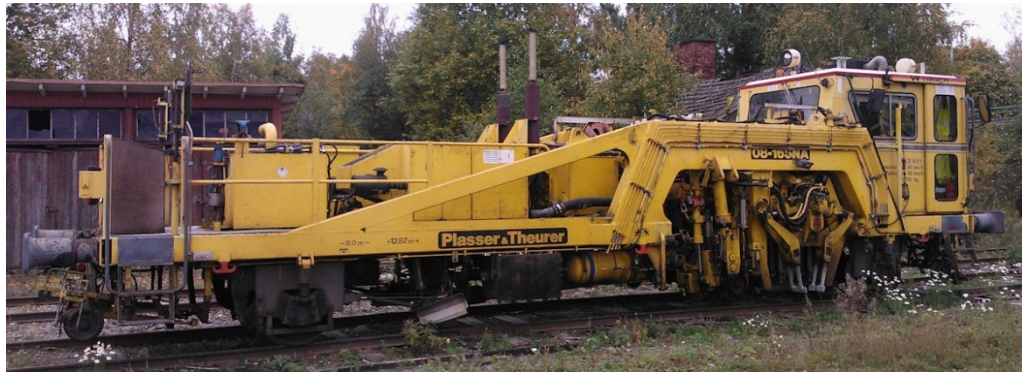
Kuva 5.37. Plasser & Theurer 08-16 SNA vaihteentukemiskone (Ttk2 851) Toijlassa syksyllä 2013. Työskentelysuunta kuvassa oikealle. Muokattu lähteestä [87]
