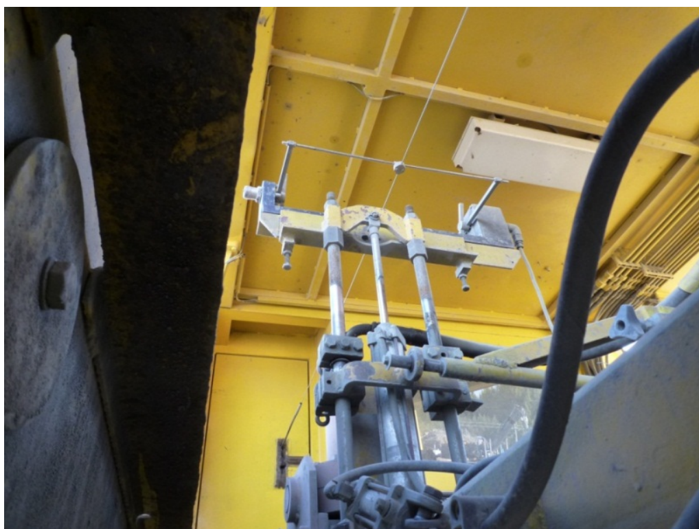
Kuva 5.5. Tukemiskoneen 09-32 CSM nostojärjestelmän työvaa'an linkittyminen koneen läpi kulkeviin mittalankoihin. Järjestely on samanlainen molemmin puolin tukemiskonetta.
