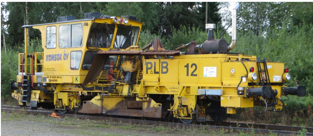
Kuva 5.55. Komsor Oy:n sepeliäura Plasser & Theurer SSP 203 (Tsl 99109425001) Kontiomäellä vuonna 2014. Koneen työskentelysuunta kuvassa oikealle. Muokattu lähteestä [103]
