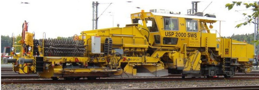
Kuva 5.57. Sepeliaura Plasser & Theurer USP 2000 SWS (Tsl 884) Jyväskylässä vuonna 2003. Koneen työskentelysuunta kuvassa vasemmalle. Muokattu lähteestä [105]
