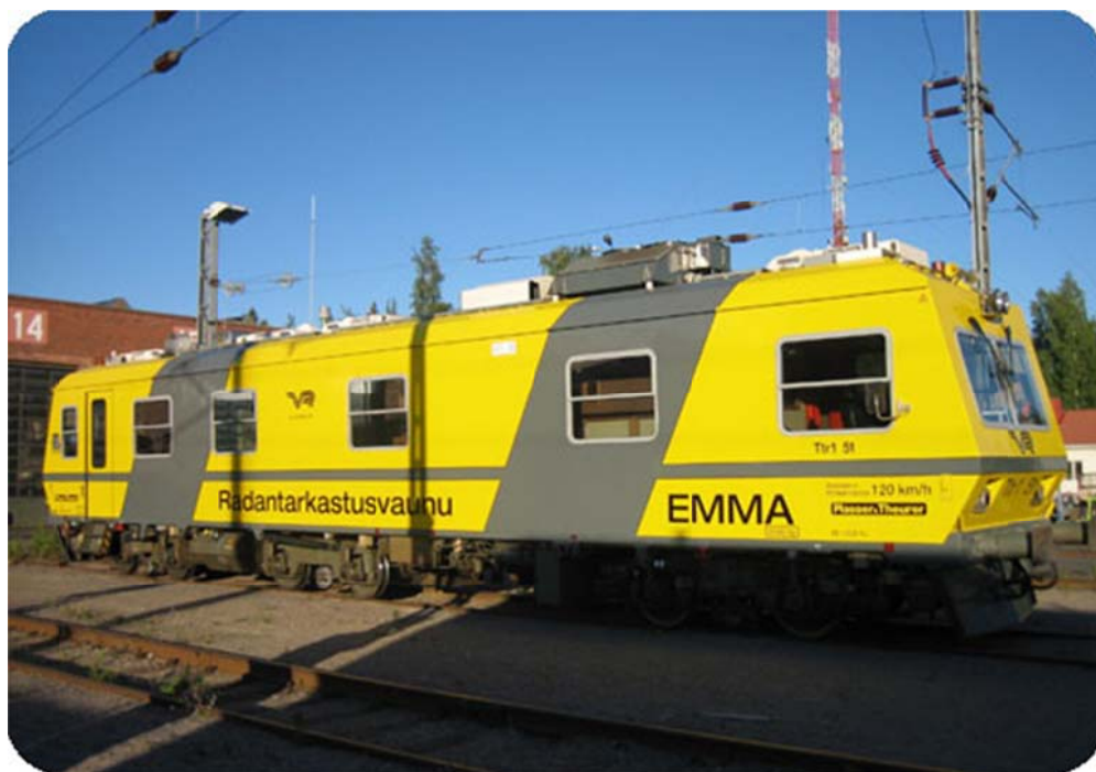
Kuva 5.2. Suomessa käytössä oleva radantarkastusvaunu Ttr1 51 (EMMA). [87]
