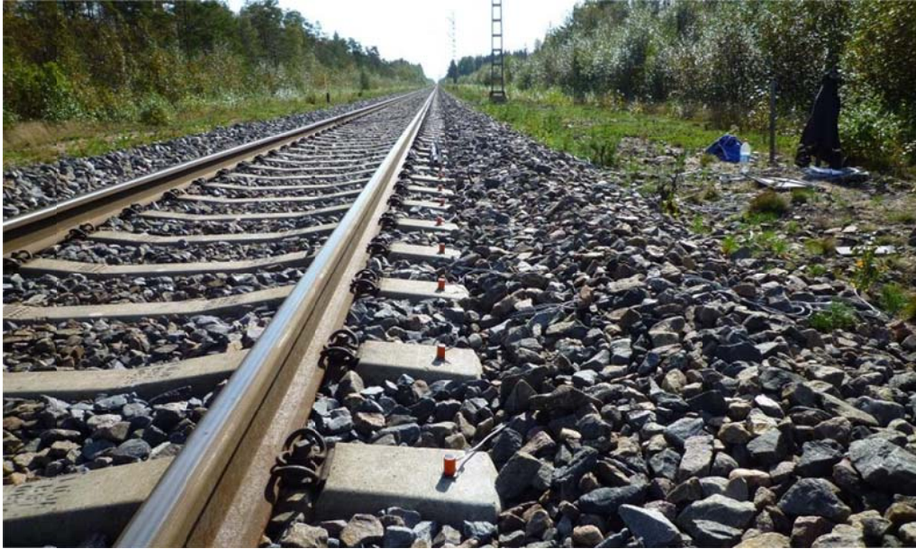
Kuva 6.3. Esimerkkikuva kiihtyvyyssanturisijoittelusta kohteissa 10–13 elokuussa 2011.
