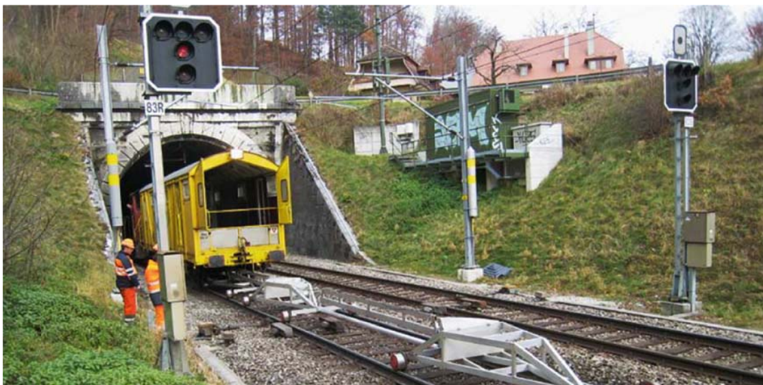
Kuva 5.13. Sveitsiläisen SBB:n radan jäykkyyden mittauslaite. [96]
