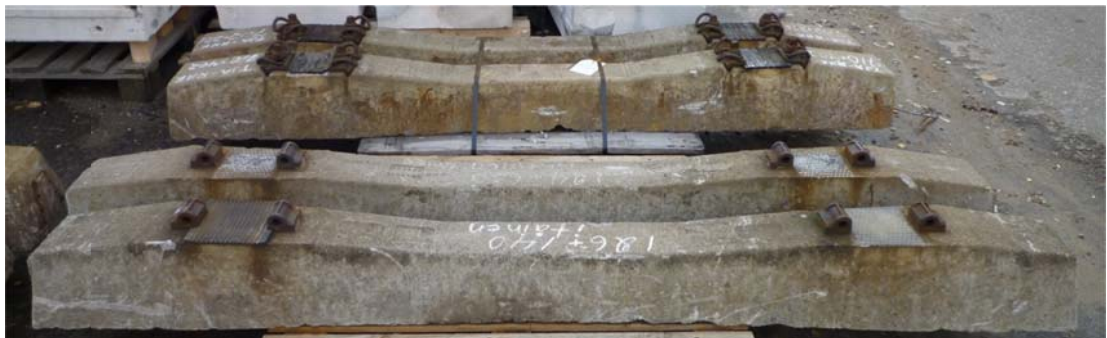
Kuva 2.9. Etummaisena kaksi BP89- ja taaempaan kaksi B97-betoniratapölkkyä.
