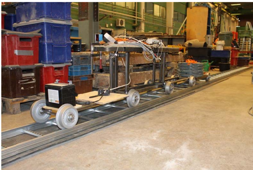
Kuva 5.16. Jatkuvatoimisen jäykkyyden mittalaitteen prototyyppi laboratoriotesteissä.
