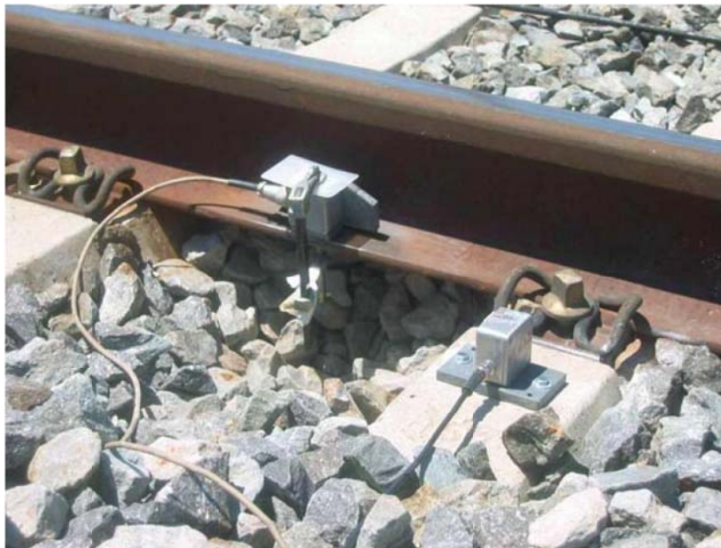
Kuva 4.26. SUPERTRACK-projektin yhteydessä kiskon jalkaan ja ratapölkyn päähän asennetut kiihtyvyyssanturit. [81]
