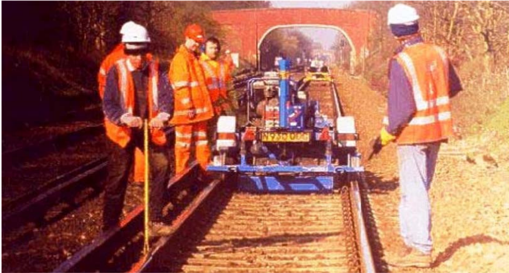
Kuva 4.1. Yleiskuva mittauksissa käytetystä modifioidusta pudotuspainolaitteesta. [66]
