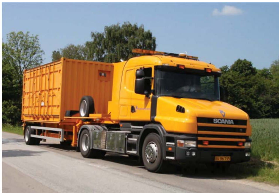
Kuva 5.14. HSD tekemässä taipumamittauksia tanskalaisella maantiellä. [99]
