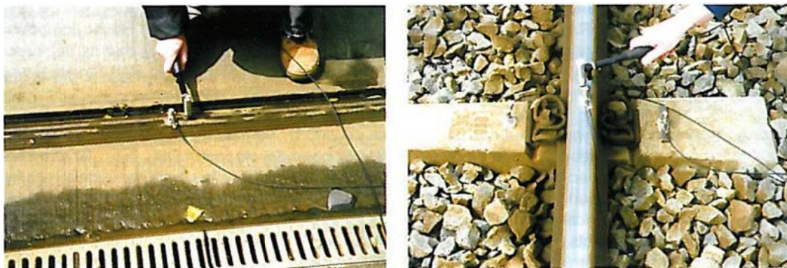
Kuva 4.33. Esimerkkejä iskuvasaratestistä ja kiihtyvyyssantureiden sijoittelusta erilaisilla radoilla. [10]
