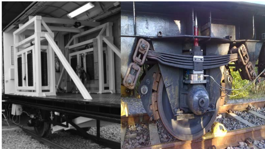
Kuva 5.5 RSMV:n rakenne. Vasemmalla kuormitettavan akselin yläpuolelle asennetut vastapainot ja oikealla lähikuva hydraulitunkilla varustetusta sekä kiihtyvyyssanturilla ja voima-anturilla instrumentoidusta akselistä. [90]
