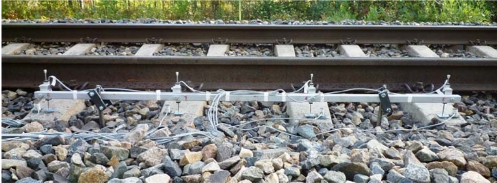
Kuva 6.6. Esimerkkikuva siirtymäanturimittausjärjestelyistä koemittauskohteissa 10–13.
