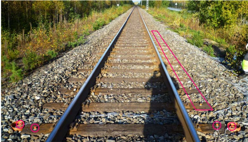
Kuva 6.2. Esimerkkikuva kiihtyvyyssanturisijoittelusta kohteissa 1–9 syyskuussa 2011.
