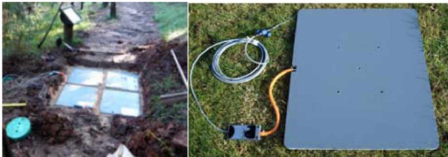
Kuva 6: Akustinen sensorilaatta. (Eco counter 2011a)
