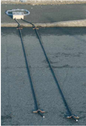
Kuva 4: Lyhytaikaisiin laskentoihin sopiva letkulaskin. (Eco counter 2010)
