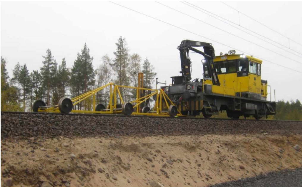
Kuva 63. Tampereen teknillisen yliopiston palautuvan painuman jatkuvatoiminen mittalaitteisto.
