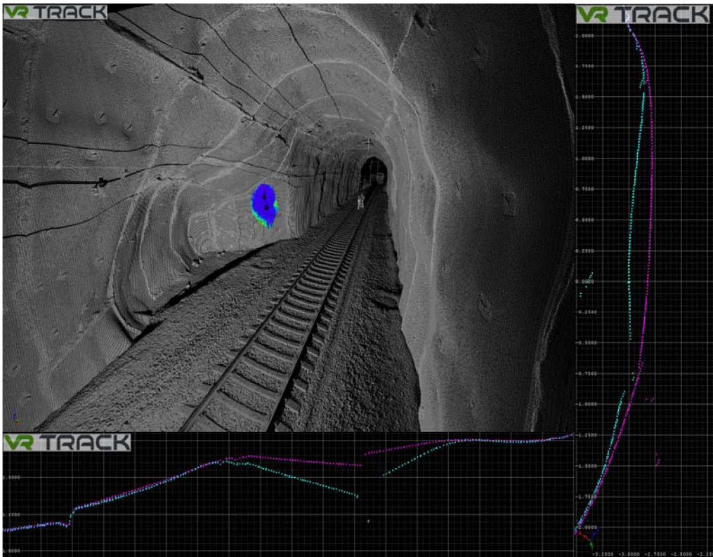
Kuva 20. Havainnosta Km 94+513.8. Kuvan vasemmassa reunassa on poikkileikkaus kohteesta. Kuvan alareunassa on tasoleikkaus kohteesta. Leikkauksissa on esitetty turkoosilla kylmän aikaan mitattu ja punaisella lämpimän aikaan mitattu.
