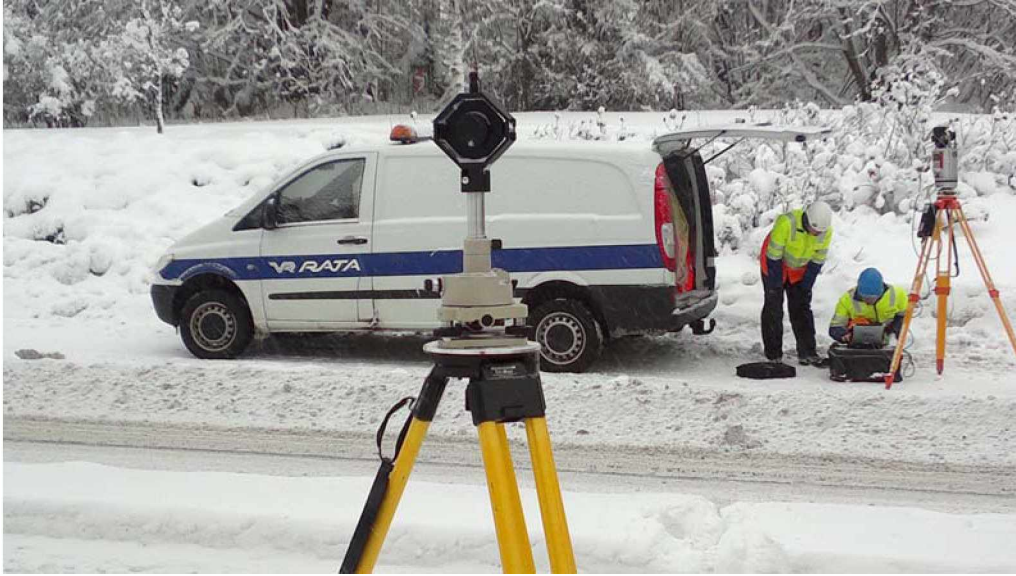
Kuva 7. Maalaserkeilain, VR Track Oy 2012
