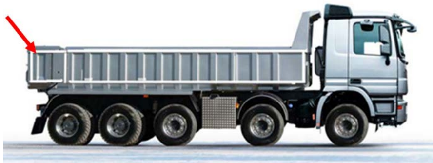
Kuva 1. Esimerkkikuva heijastavista ääriiviivamerkinnoista maansiirtoautossa. (Trafi 2011)
