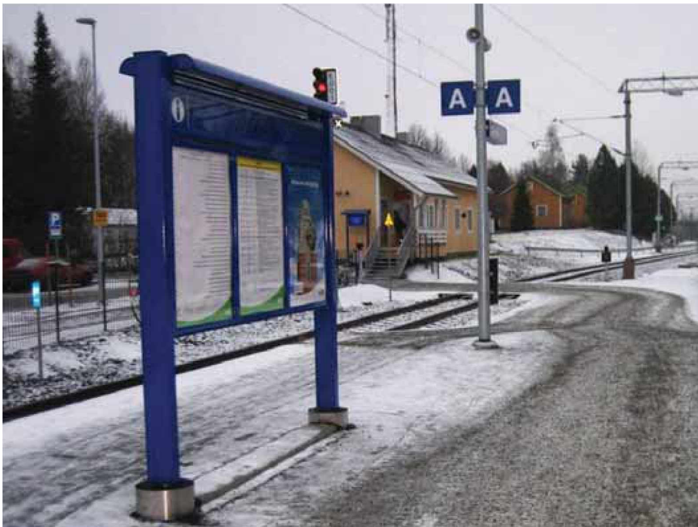
Kuva 24. Valaistu aikataulukaappi, laiturin nimikyltti ja kuulutuslaitteet tulisi olla kaikilla laitureilla. Kuvassa lisäksi sektorointipasteet. (kuva Jämsä).
