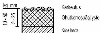
Kuva 14. Betoni-, teräs- tai puukantisen sillan ohutkerospäälylyste.
