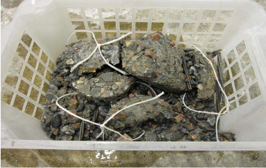
Kuva 63. Rapautunut näyte-erä 25 jäädytys-sulatus-syklin jälkeen.
