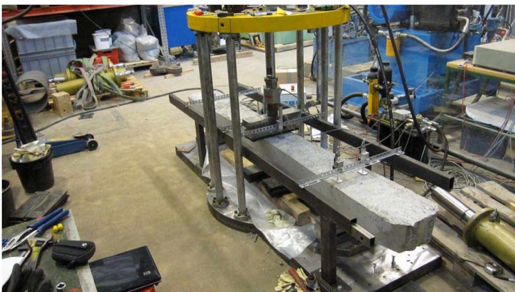
Kuva 28. Ratapölkyn keskiosan kuormittamiseen muokattu kuormituskehä.
