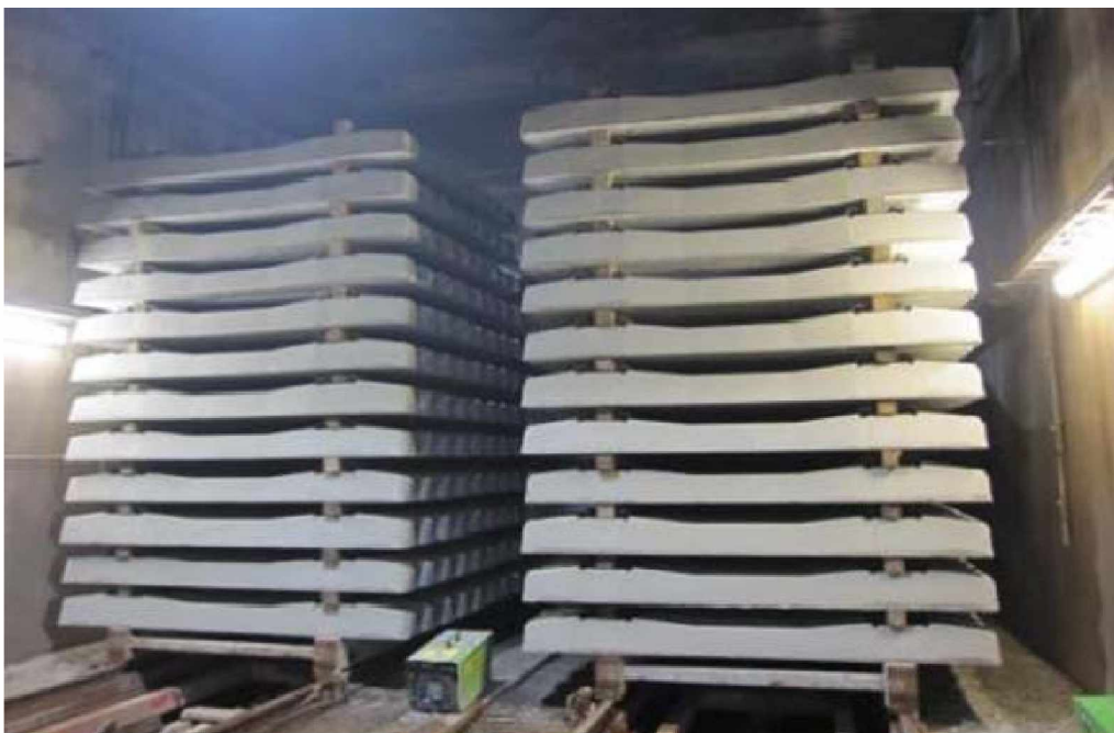
Kuva 4. Lujabetoni Oy:n käyttämä jälkikäsitelytila, jossa ratapölkkyt pidetään riittävän kosteina seitsemän vuorokauden ajan ilman jälkihoitoainetta.
