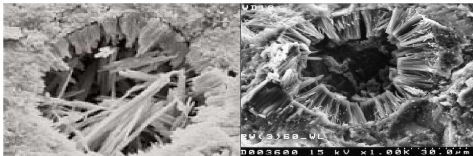
Kuva 14. Ettringiittiä betonin ilmahuokosissa. Ilmahuokokset ovat tyypillisesti halkaisijaltaan noin 0,025-0,05 mm [71].
