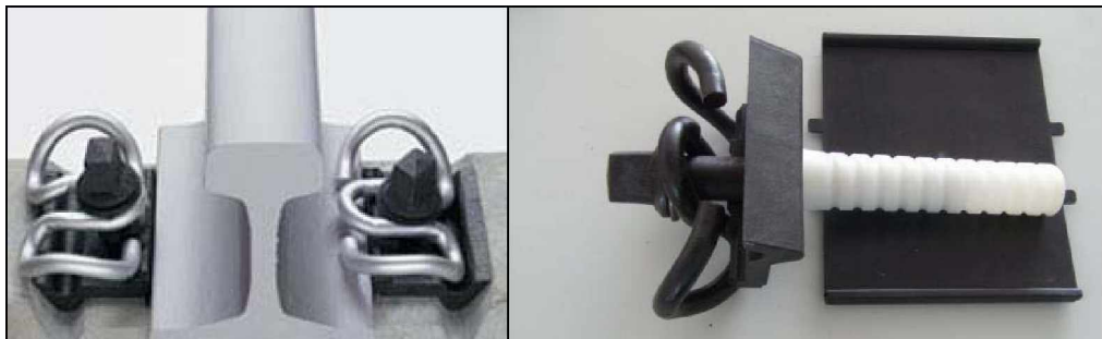
Kuva 2. Vossloh Skl 14-kiinnitys. Oikeanpuoleisessa kuvassa raideruuviholkki, välilevy, raideruuvi, kiinnitysrousu ja kulmakappale [79].
