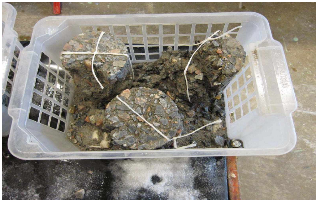
Kuva 62. Rapautunut näyte-erä 17 jäädytys-sulatus-syklin jälkeen.
