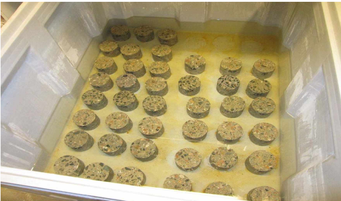
Kuva 48. Näytteet veteen upotettuina kyllästämisen aikana
