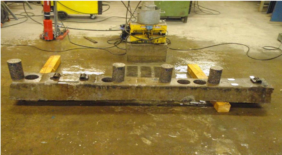
Kuva 47. Ratapölkystä poratut näytteet odottamassa 100 mm korkuisiksi sahaamista.
