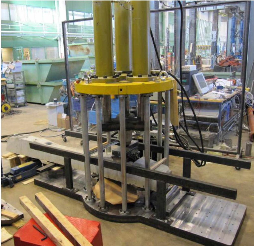
Kuva 26. Kokeita varten rakennettu kuormituskehä.
