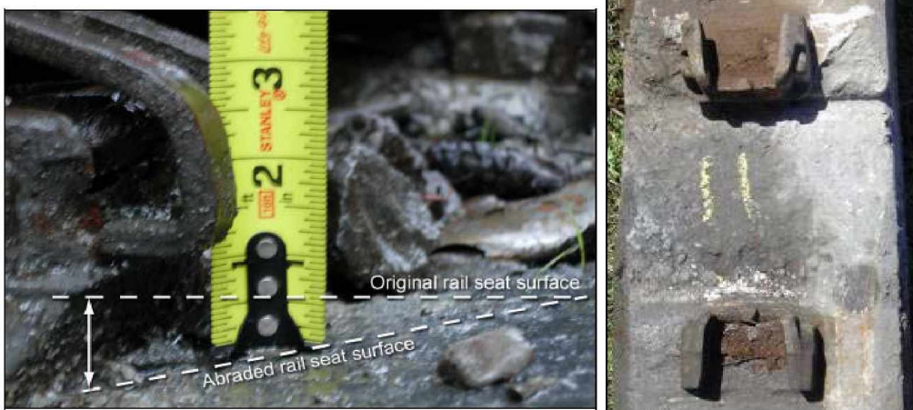
Kuva 24. Ratapölkyn kuluminen. Kiskon kiinnityskohta on kulunut enemmän toiselta laidalta, koska ratapölkky on sijainnut kaarteessa [82].
