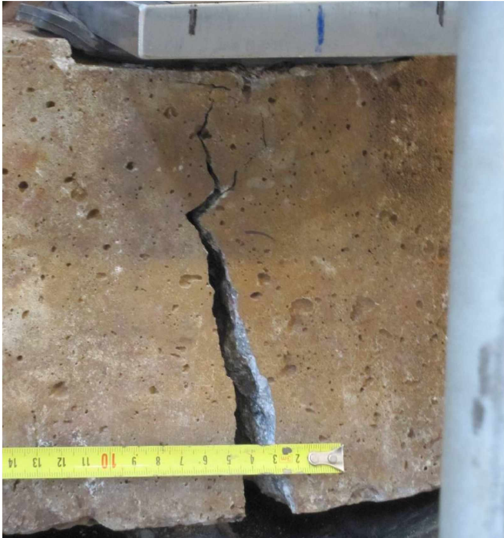
Kuva 52. B75-ratapölkky kuormitettuna 360 kN voimalla pölkyn pään staattisessa kuormituskokeessa.
