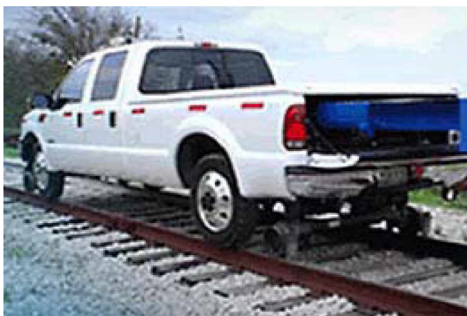
Kuva 5.29 AURORA-järjestelmä kytkettynä raiteilla kulkevaan ajoneuvoon (Georgetown Rail 2011).
