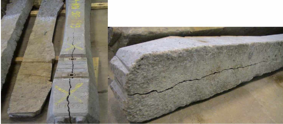
Kuva 5.12 Pituussuuntaan haljenneita ratapölkkyjä.
