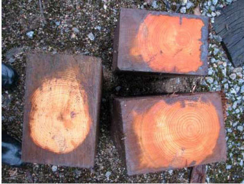
Kuva 6.5 Koekappaleita kreosoottikyllästetyistä mäntypuuratapölkkyistä (Tunninen 2007).
