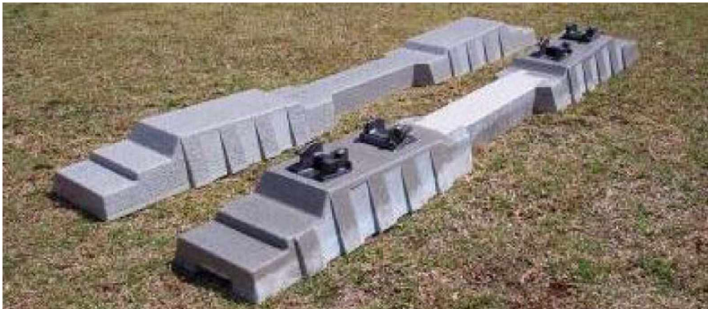
Kuva 6.11 CEEFC:n kehittämä uusi pölkky malli (Manalo 2011).
