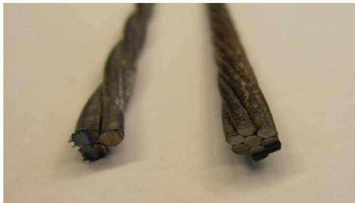
Kuva 2.2 Vasemmalla halkaisijaltaan 6,5 mm kolmilankainen jänneteräspunos ja oikealla halkaisijaltaan 6,4 mm seitsemänlankainen jänneteräspunos.
