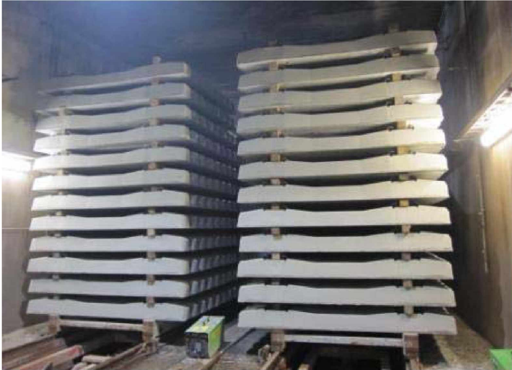
Kuva 2.16 Lujabetoni Oy:n käyttämä jälkikäsitteilytila, jossa ratapölkkyt pidetään riittävän kosteina seitsemän vuorokauden ajan ilman jälkihoitoainetta.
