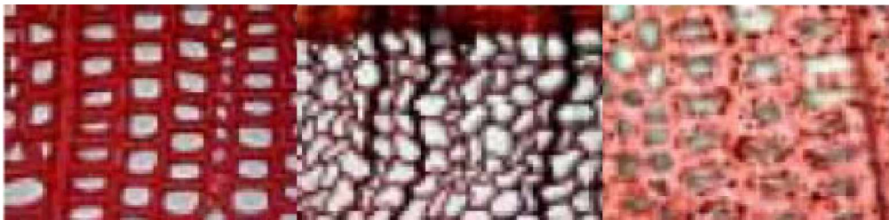
Kuva 6.4 Vasemmalla terveen puun solukkoa, keskellä ruskolahon vaurioittamaa solukkoa ja oikealla katkolahon vaurioittamaa solukkoa (Boren 2010).
