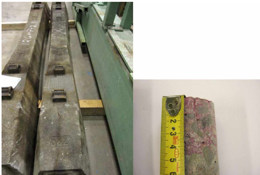
Kuva 5.13 Oikealla pituussuunnassa haljennut pölkky ja vasemmalla pölkystä halkeaman kohdalta porattu näyte.
