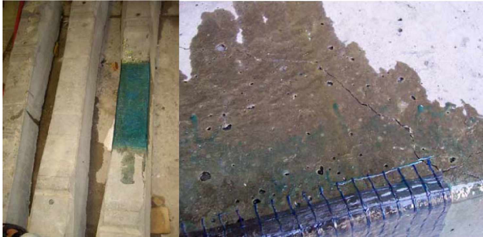
Kuva 6.14 Vasemmalla pölkyn yläpinnasta keskeltä vahvistettu ratapölkky ja oikealla halkeaman syntykohta (Shokrieh & Rahmat 2006).
