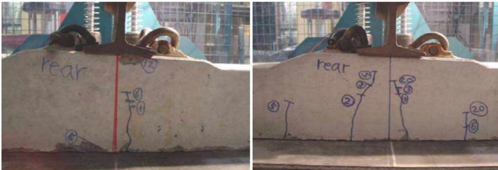
Kuva 5.6 Ratapölkkyjen kunto pudotusten jälkeen. Vasen kuva: iskuvaikutus 500 kN. Oikea kuva: iskuvaikutus 810 kN (Kaewunruen & Remennikov 2010).
