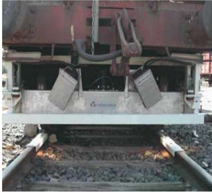
Kuva 5.32 IVOIRE järjestelmä kiinnitettynä tavaravaunuun (Cybernétix 2011).
