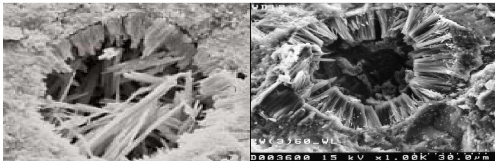
Kuva 5.7 Ettringiittiä betonin ilmahuokosissa. Ilmahuokokset ovat tyypillisesti halkaisijaltaan noin 0,025–0,05 mm (Stark J. & Bollmann 2010).
