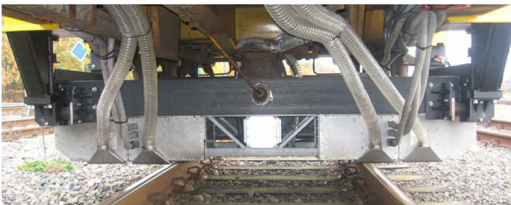
Kuva 5.34 Kameralaitteisto kiinnitettynä mittausvaunuun (EURAILSCOUT 2011).
