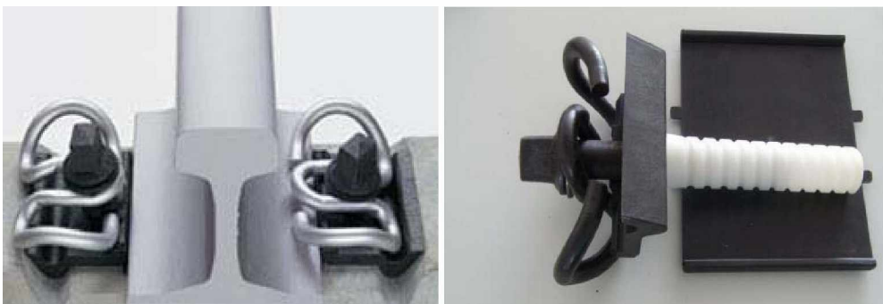
Kuva 2.11 Vossloh Skl 14-kiinnitys. Oikeanpuoleisessa kuvassa raideruuviholkki, välilevy, raideruuvi, kiinnitysrousu ja kulmakappale (Vossloh 2010).
