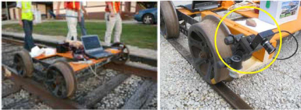
Kuva 5.22 Kiskoilla liikuttettava vaunu, johon kamerat ja mittalaitteet ovat asennettu (Edwards et al. 2009).
