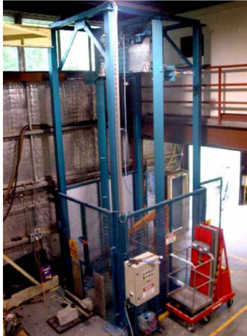
Kuva 5.4 Iskustestauslaitteisto (Kaewunruen & Remennikov 2010).
