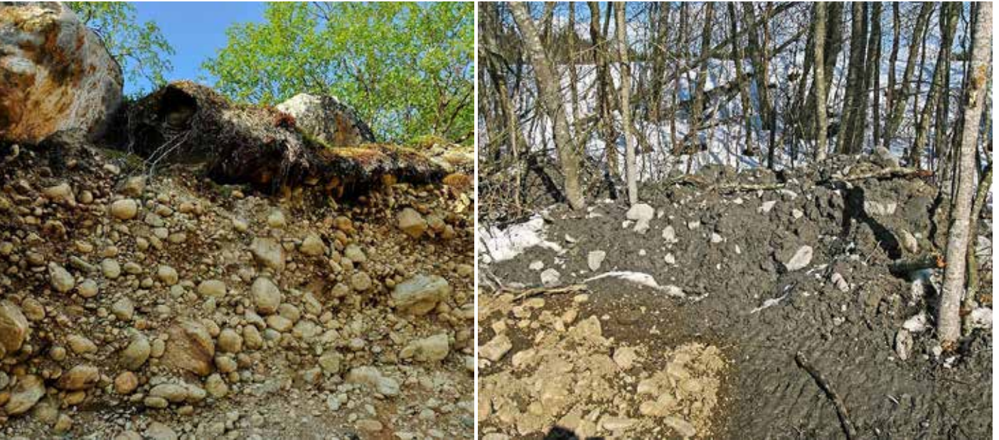
Kuva 25. Ylitysrakenteen kaivaminen lajittuneeseen maaperään aiheuttaa usein huomattavia ja pitkäaikaisia eroosio-ongelmia (vas). Savipitoinen maaperä on puolestaan riskialtis veden samentumis- ja kantavuusongelmien vuoksi (oik).
