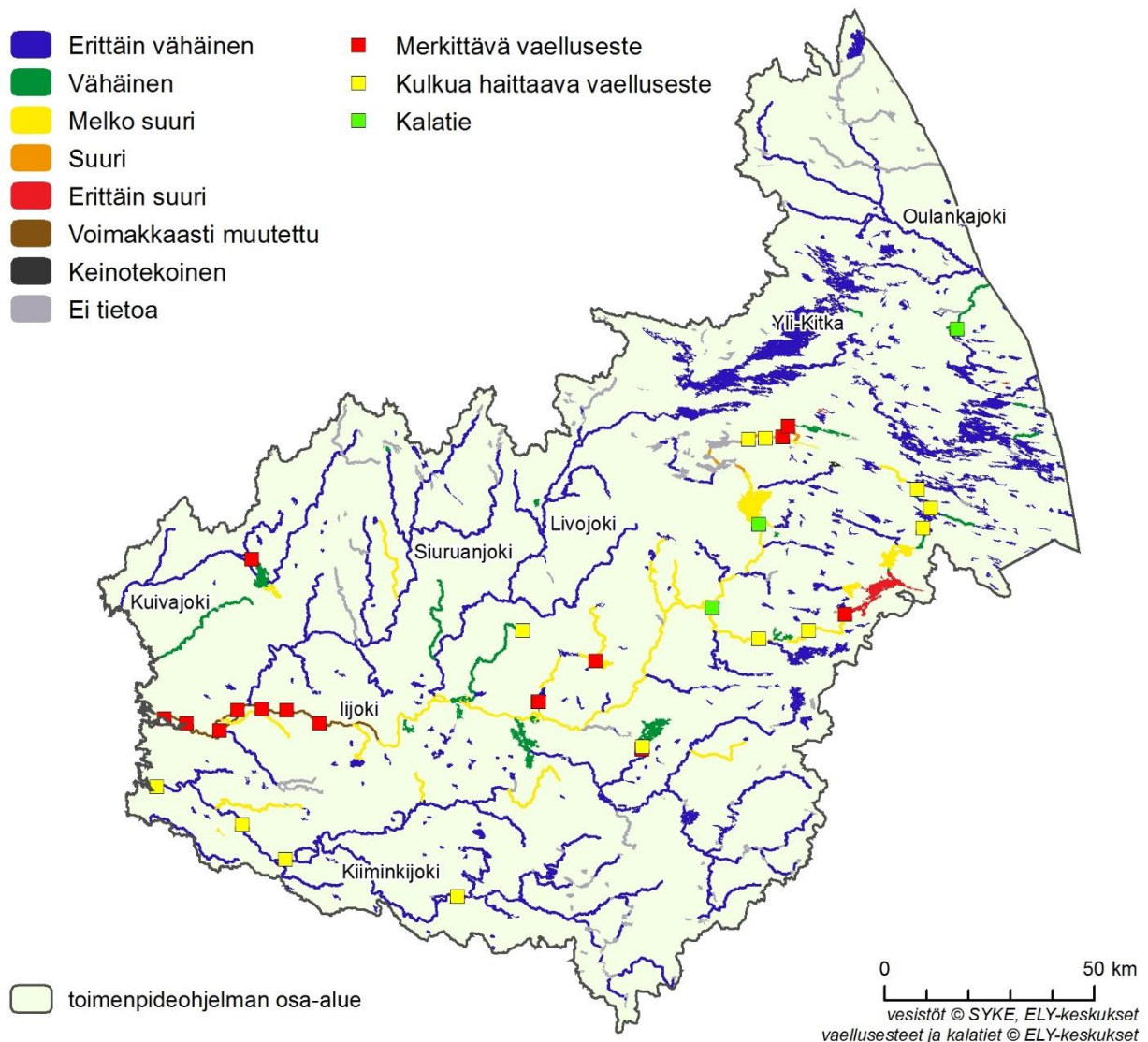
Kuva 4.4. Säännöstelyn ja vesirakentamisen aiheuttamat muutokset osa-alueen vesien hydrologis-morfologisessa tilassa sekä osa-alueen vaellusesteet ja kalatiet. Kartasta puuttuvat padot, jotka eivät muodosta vesieliöille vaellusesteitä sekä padot, joiden merkitys vaellusten kannalta ei ole tiedossa.
