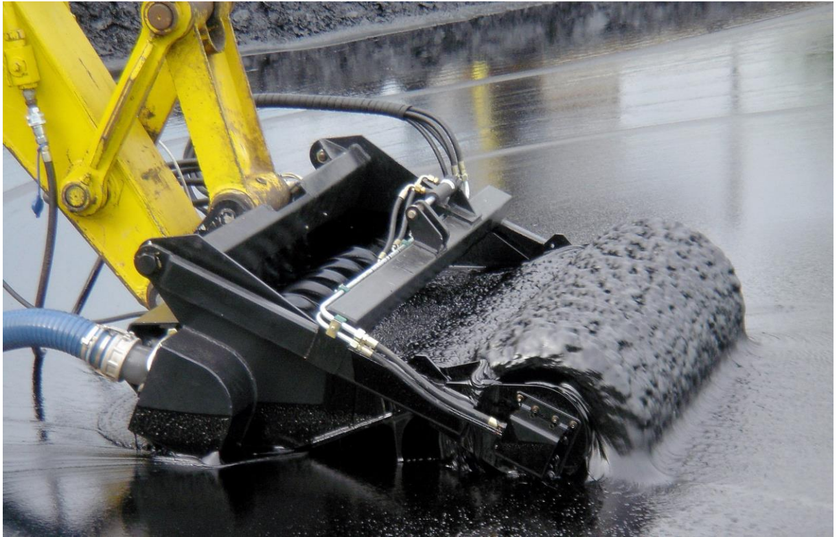
Kuva 12. Lamorin valmistama LRB-öljynkeräyskauha. [16]
