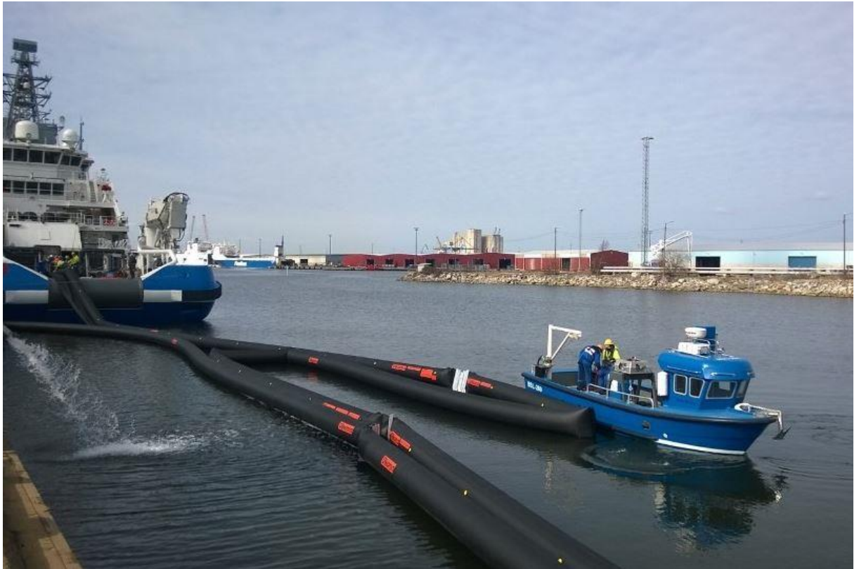
Kuva 11. Vikoman Bulkhead -avomeripuomia ja vartiolaiva Turvan työvene. [33]
