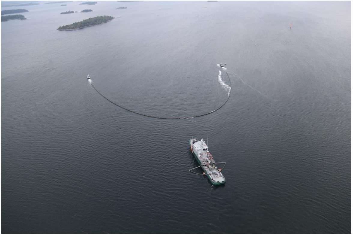
Suomessa yleisesti käytetty nuottaustekniikka; Kaksi partiovenettä nuottaamassa ja keräävänä aluksena vartiolaiva Uisko Länsi-Suomen merivartiostosta [28]
