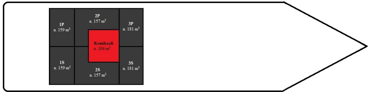
Kuva 13. Öljyn- ja kemikaalinkeräystankkien sijainti ja tilavuudet. [28]
