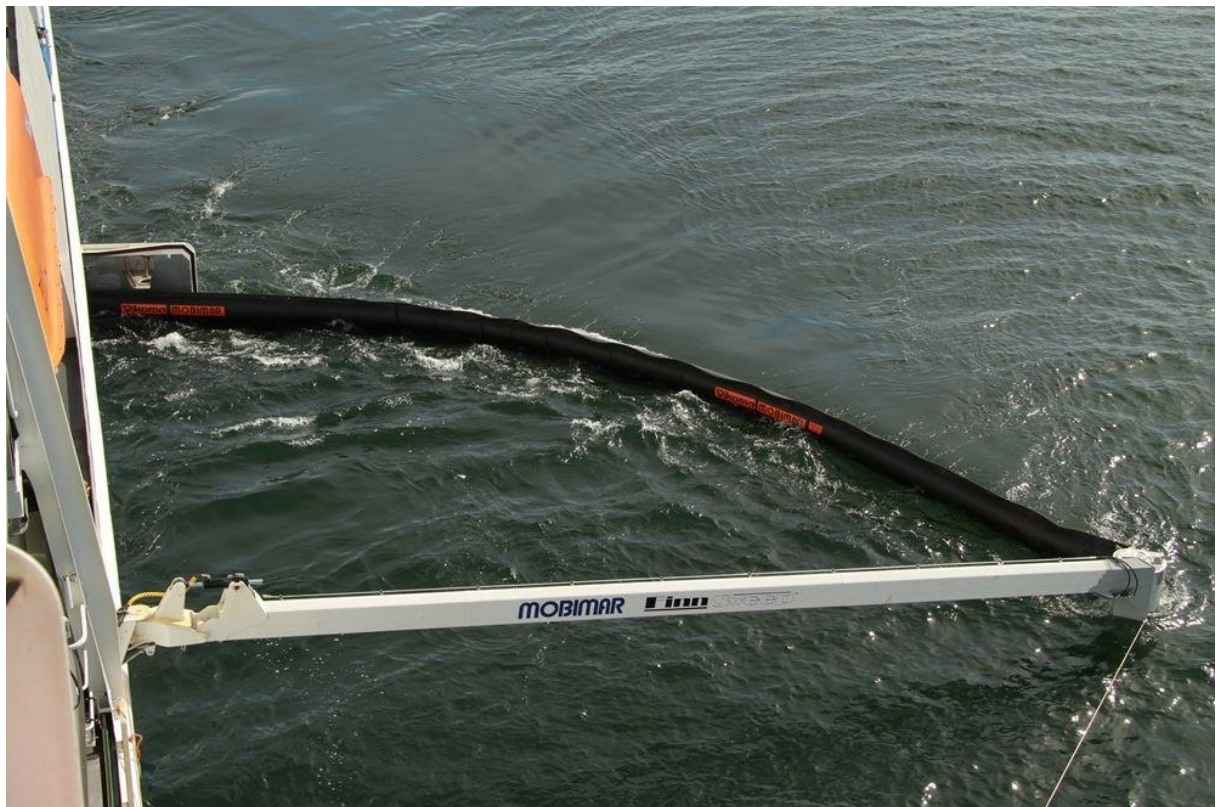
Kuva 8. Mobimarin FinnSweep®-loitonnuosuomi ja Vikoman HI Sprint™ -levityspuomi vartiolaiva Turvan vasemmalla kyljellä. [33]
