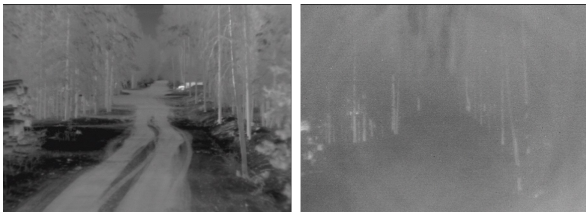
Kuvat 3a ja 3b. Lämpökameran kuvat tiestä selkeässä säässä (a) ja lumisateessa (b). 56
