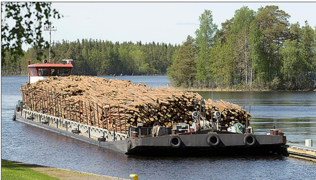
Kuva 2-10. Parkko-aluksen ja Sampo-proomun yhdistelmä vetää 2 000 m 3 eli noin 40 rekkalastillista puuta. Kuvalähde: Metsähallitus.
