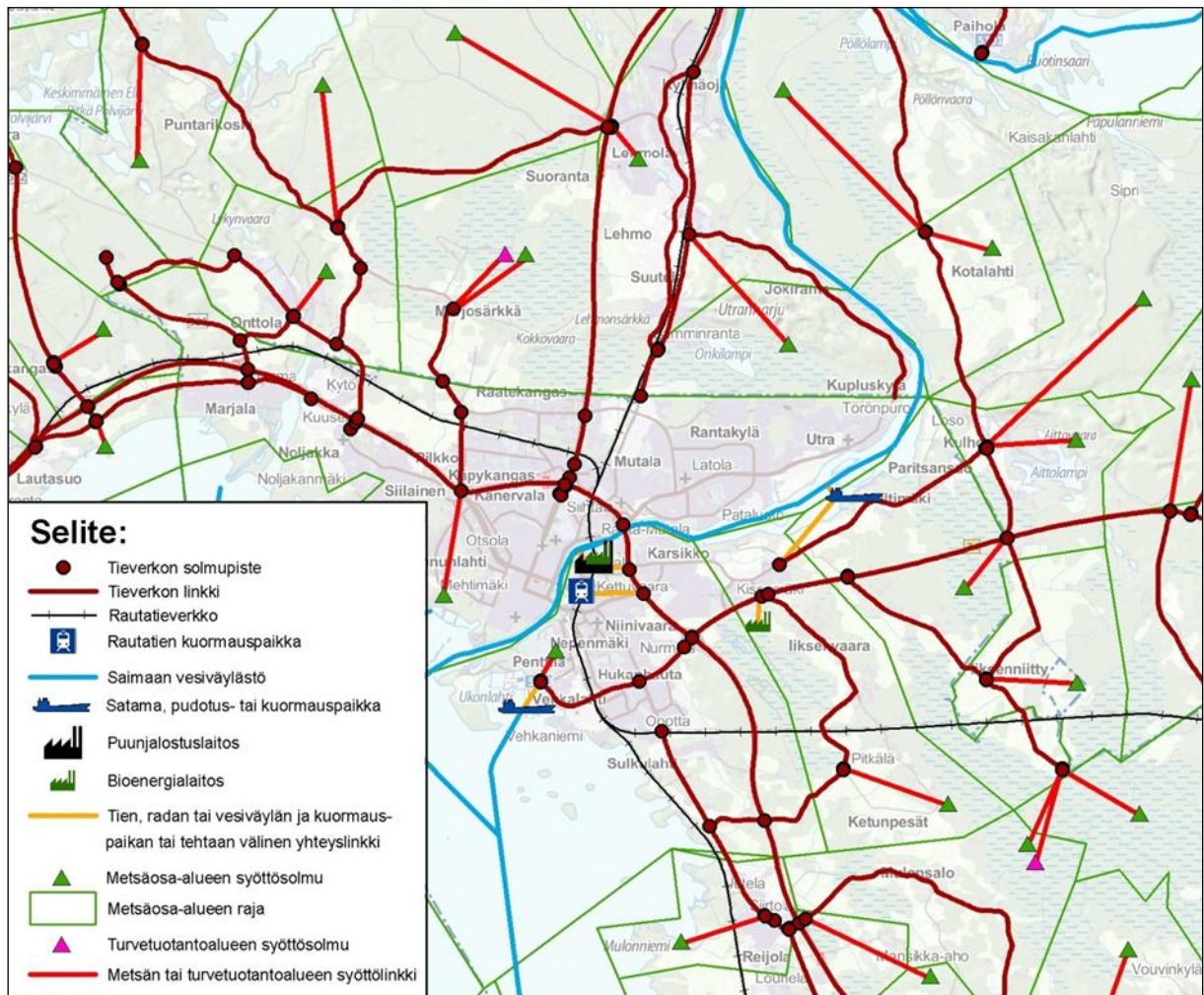
Kuva 3-4. Esimerkki eri kuljetusmuotojen Emme-verkkokuvauksesta, metsäpienaluejaosta sekä metsäalueiden, turvetuotantoalueiden ja tuotantolaitosten kytkennästä Emme-verkkoon. Kuvasta käy ilmi rautatielastauspaikkojen ja vesitietermiinaalien kytkentä yhteyslinkeillä maantieverkkoon.
