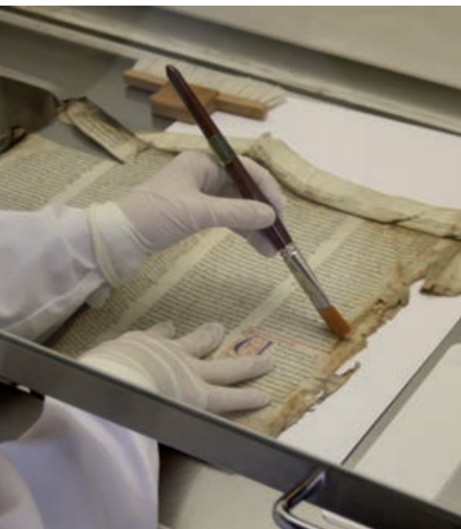
Homevaurioituneen pergamenttilehden puhdistus vetokaapissa.
