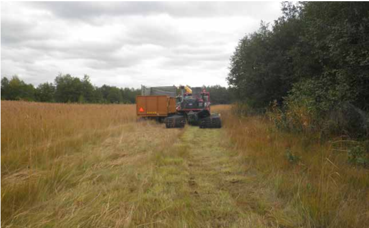
Kuvan laitteisto mahdollistaa yhtäaikaisen niiton ja niittojätteen poiskeruun (valmiiksi silputtuna ja suoraan esimerkiksi kompostoitavaksi soveltuvana). Koneiden pienen pintapaineen omaava telaketjusto estää vakavat vauriot kosteilla ja pehmeäpohjaisilla ranta-niityillä. Laitteita on käytetty myös rantaniittyjen kunnostukseen, äestämiseen ja murskaukseen – lisälaitteita vaihtamalla.
