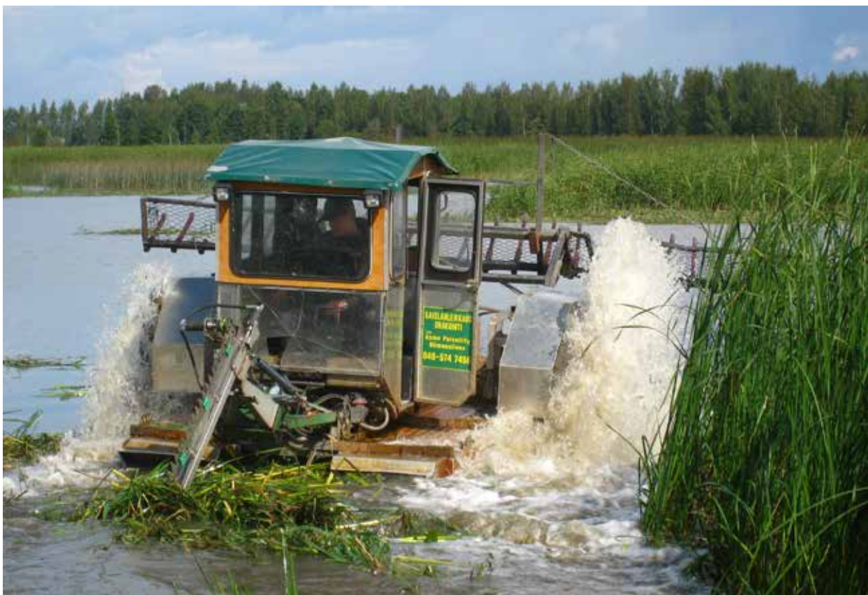
Truxor-niittokone on tela-alustainen ja kelluva. Se soveltuu vedessä kasvavien ruovikoiden ja muun vesikasvillisuuden niittoon. Kuva: Terhi Ajosenpää
