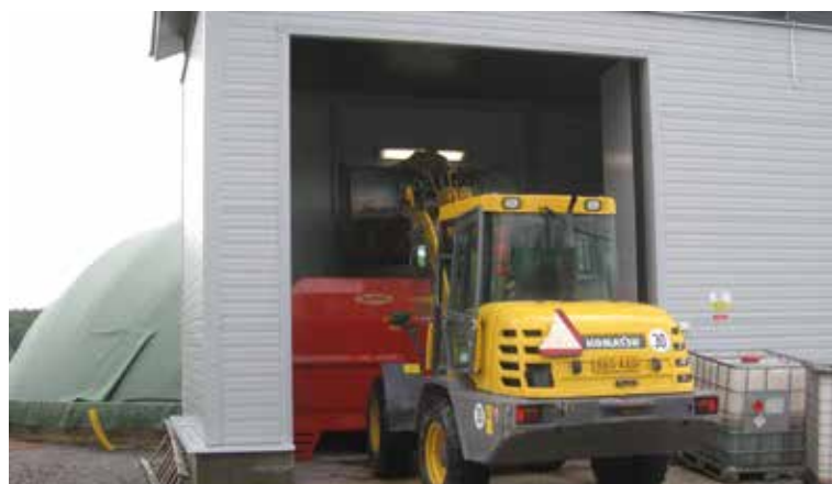
Ruokoa lisätään biokaasulaitokseen apevaunun kautta. Kuva: Terhi Ajosnpää
