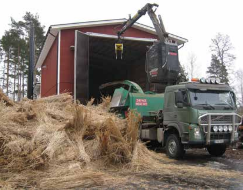
Talviruokoa silputtiin rumpuhakurilla suoraan Taivassalon lämpölaitoksen varastoon. Silppu oli erittäin tasalaatuista ja lyhyttä (2-5 cm). Kuva: Terhi Ajosenpää
