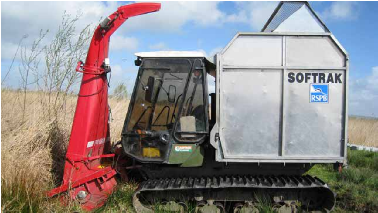
Englantilaisen Loglogicin Softrak-niittokone puhalttaa leikatun ja silputun ruo'on koneen takana olevalle lavalle. Kuva: Terhi Ajosenpää
