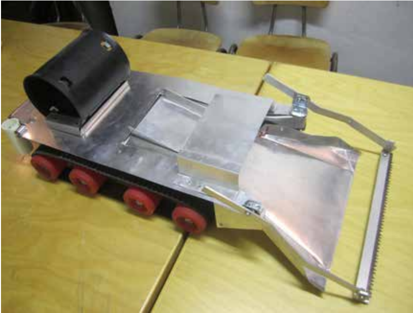
Ruovikonkorjuukonekursilla kehitetty prototyyppi ruokoa leikkaavasta ja paa-laavasta niittokoneesta. Kurssin järjestivät Perniön keksijäyhdistys ja Salon kansalaisopiston AKVA-hanke. Kuva: Päivi Joki-Heiskala
