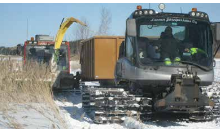
Rinnekone-kaksoissilppuri –yhdistelmä sopii hyvin talviruo'on leikkuuseen. Tuulinen sää aiheutti jonkin verran korjuutappioita. Kuvat: Terhi Ajosenpää
