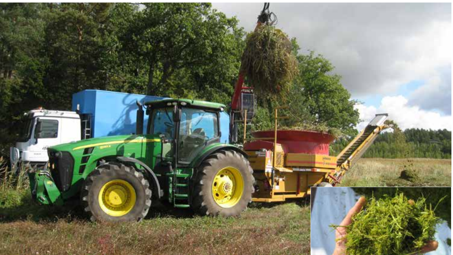
Haybuster-jauhinmurskain teki ruo'osta hienojakoista murskaa noin 20 tonnin tuntivauhdilla. Kuvat: Terhi Ajosenpää
