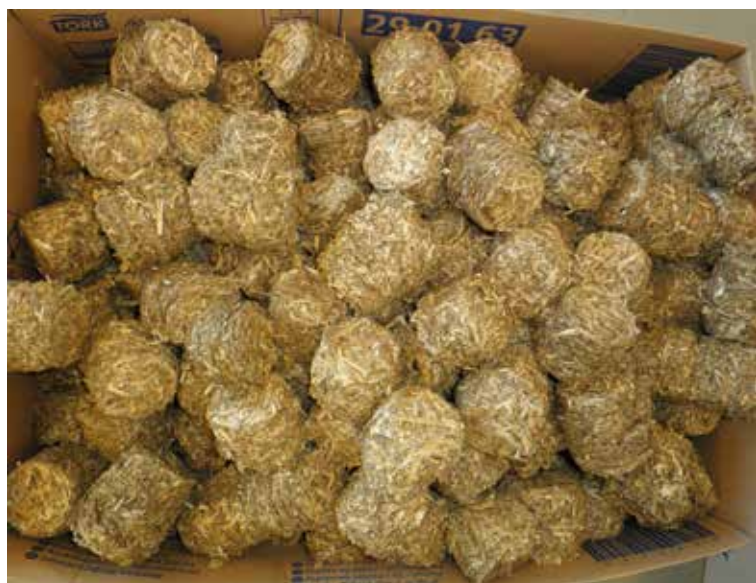
Talviruo'osta tehdyt briketit olivat herkkiä murenemaan. Käsiteltävyys paranee puristuspainetta lisäämällä. Kuva: Mika Orjala
