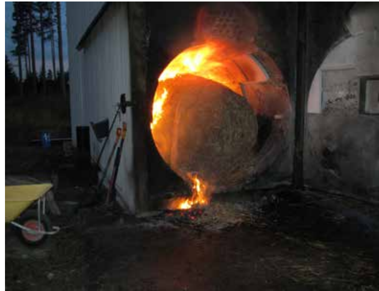
Ruokopaali syttyi helposti ja tuli levisi nopeasti ruokopaalin pinnalle. Kuva Rekikosken tilan paalikattilasta. Kuva: Kari Paassilta
