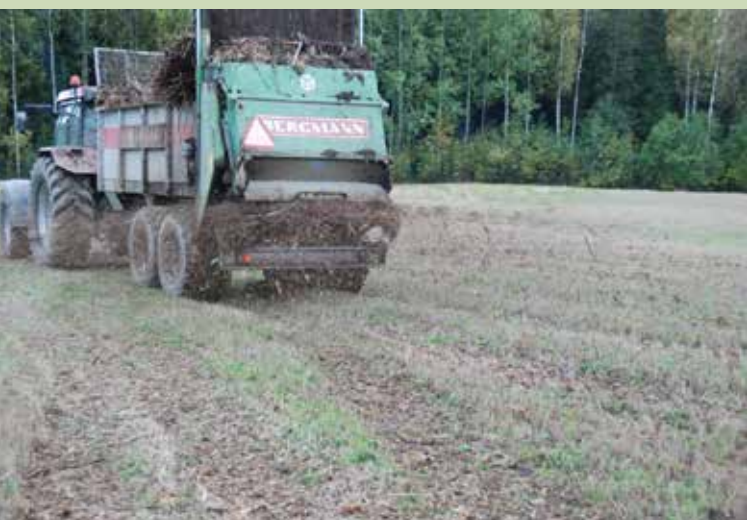
Levitys lannanlevitysvaunulla (Bergmann täsmälevitin) sujui ongelmitta ja silppu levittyi tasaisesti peltoon. Kuva: Olli Välttilä
