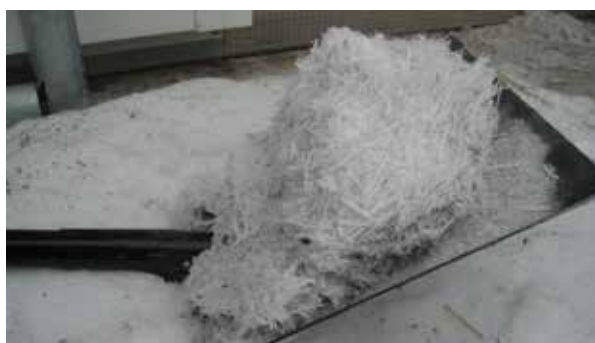
Ruokosilppu paloi hyvin Väkiparran tilan lämpölaitoksessa muodostaen valkoista tuhkaa. Pitkät korret vaikeuttivat polttoaineen kuljetusta pesään. Kuvat: Terhi Ajosenpää
