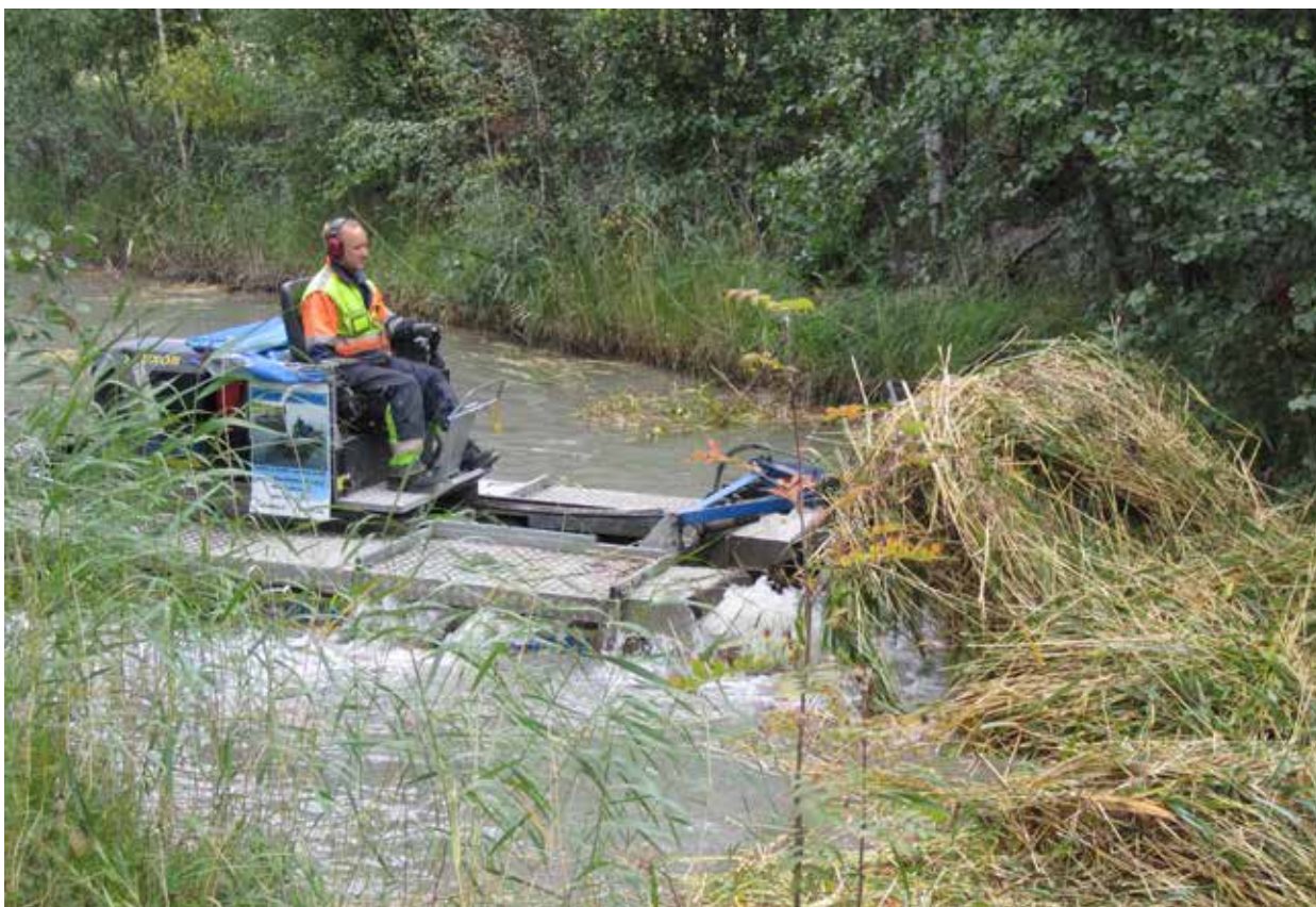
Vesileikkuun hitain vaihe on ruokolauttojen työntäminen rantaan. Kuva: Terhi Ajosempää
