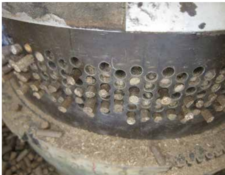
Lokapelletin pelletöintilaitteessa käytettiin 50 mm matriisia. Kuva: Tuomas Aljoki
