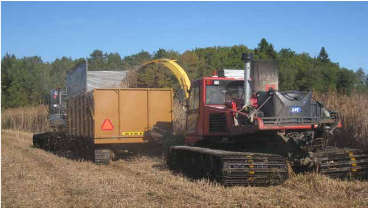
Leikkumassan keräävä rinnekone-kaksoissilppuri -yhdistelmä toimi hyvin maaruovikon niitossa. Kuva: Terhi Ajosenpää
