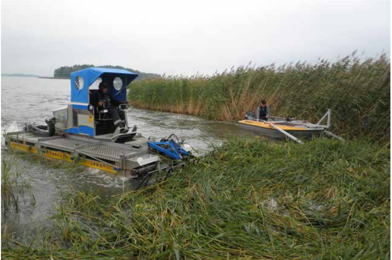
Truxor ja keruuvene työntävät leikatut ruo'ot lauttoina rantaan. Kuva: Ritva Kempainen
