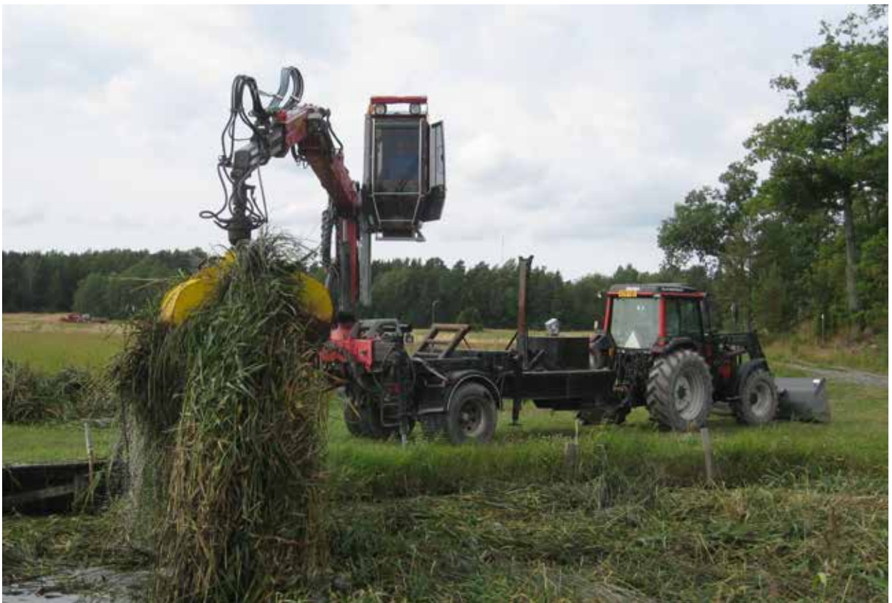
Juurikaskoura sopii hyvin ruokomassan nostoon. Kuvat: Terhi Ajosempää
