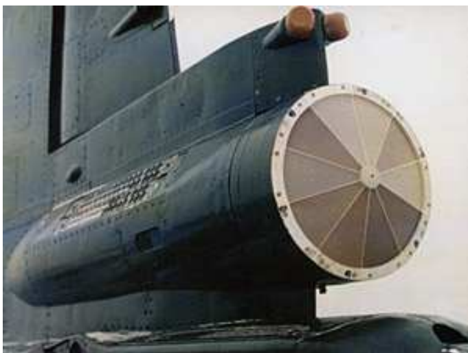
Kuva 23: L-166SI – häirintäjärjestelmän lähetin SU-25T rynnäkkökoneeseen asennettuna. [32]
