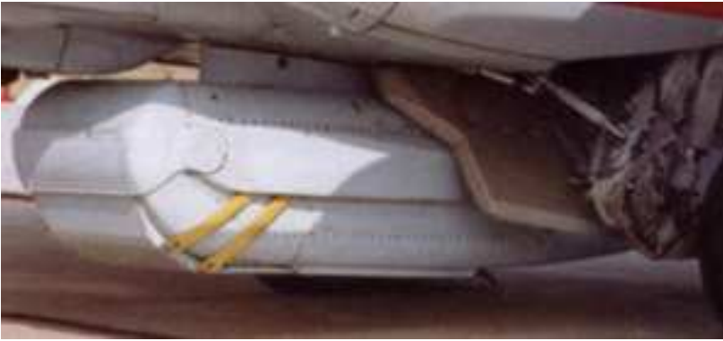
Kuva 21: Mercuri LLLTV -järjestelmän kamerasäiliö SU-25TM rynnäkkökoneessa. [32]
