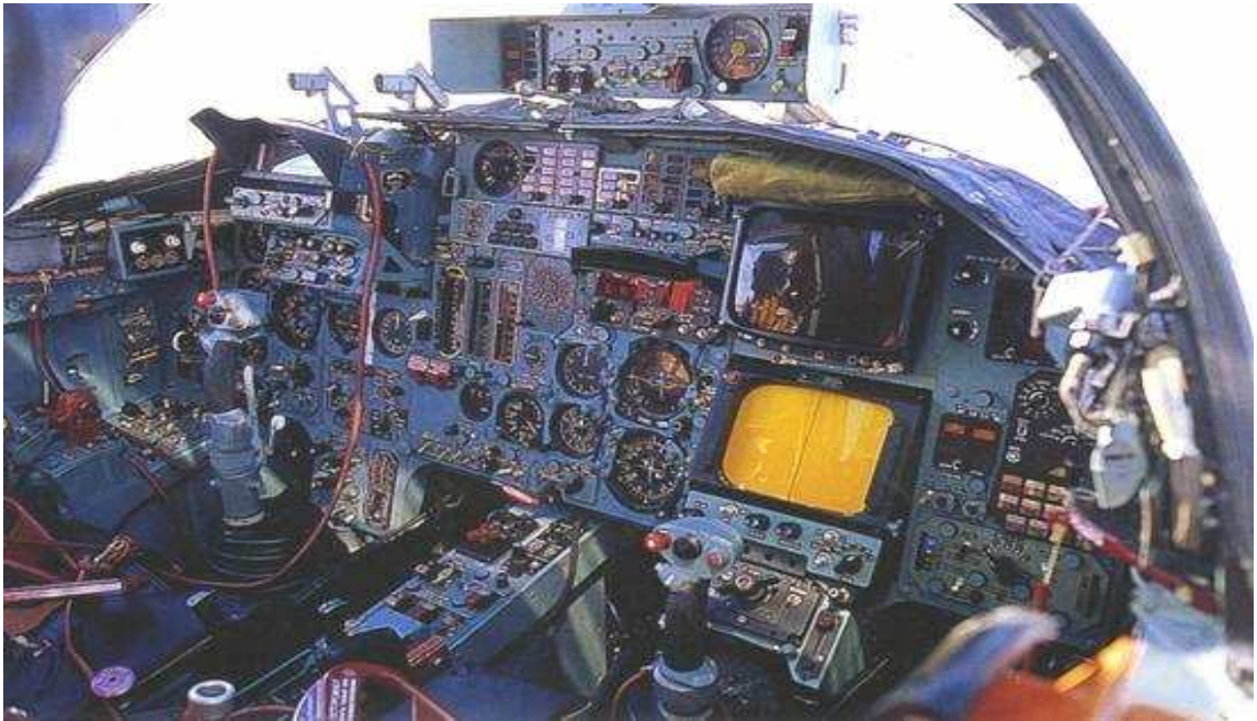
Kuva 7: SU-24 rynnäkkökoneen sisäänrakennettu suunnistus- ja tähtäysjärjestelmä PNS-24 ohjaamossa oikealla. [12]
