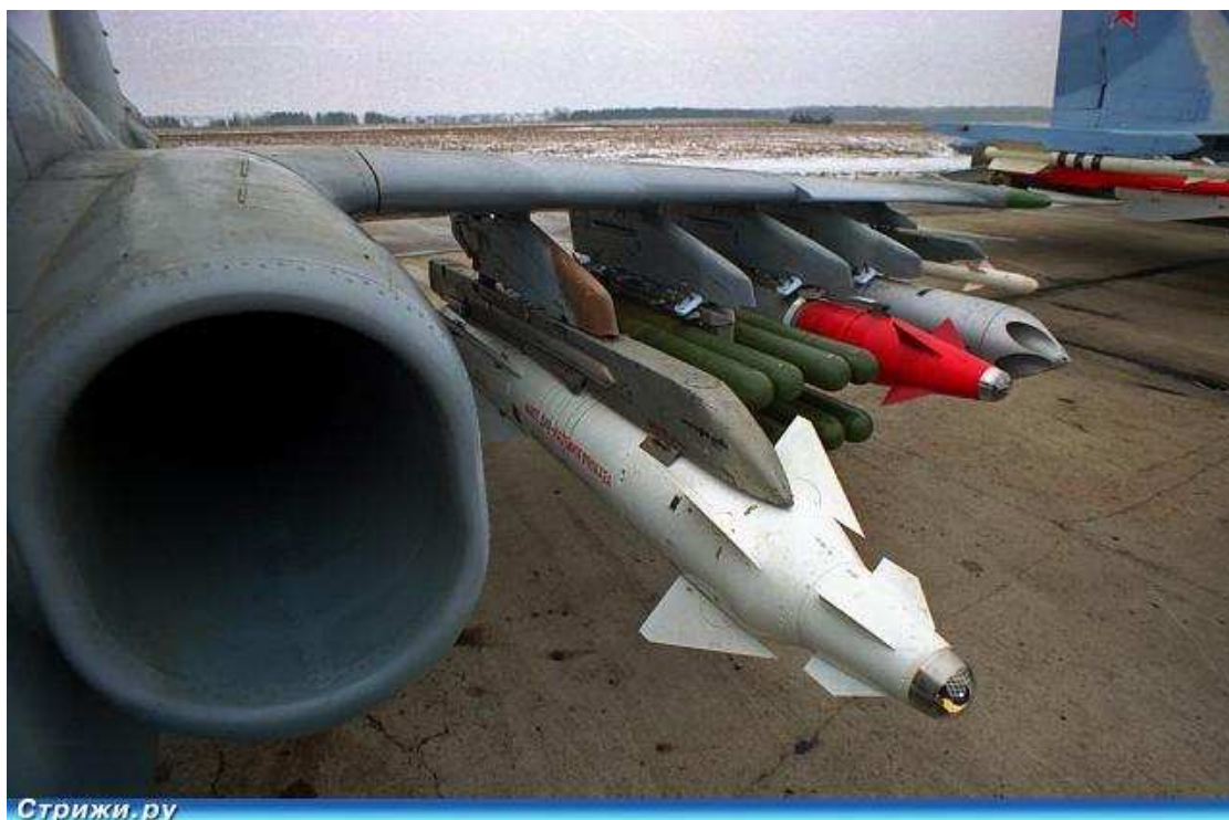
Kuva 25: SU-25TM koneeseen kiinnitettyinä ovat vasemmalta alkaen Kh-29L, AT-16 Vihri, Kh-25, rakettisäiliö ja R-27T ilmataisteluohjus. [11]
