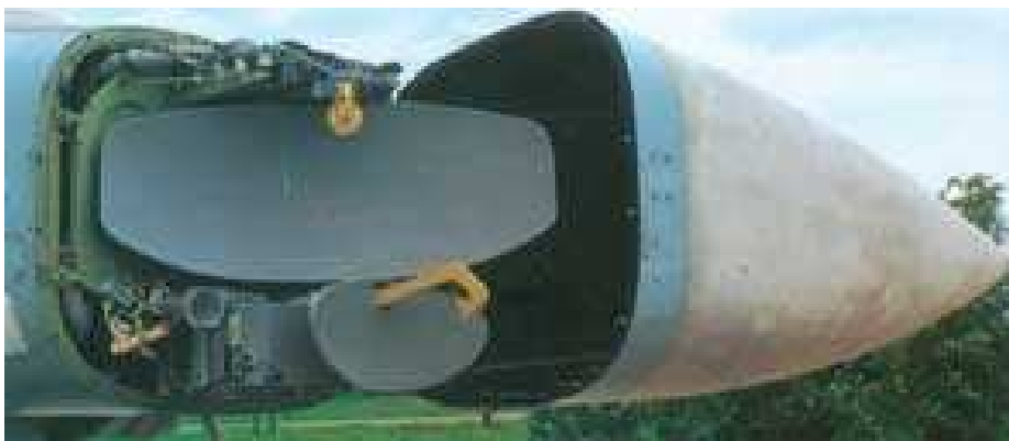
Kuva 5: Orion-A rynnäkkötutka ylempänä ja Relief -maastonseurantatutka alempana SU-24 rynnäkkökoneen nokassa. [32]
