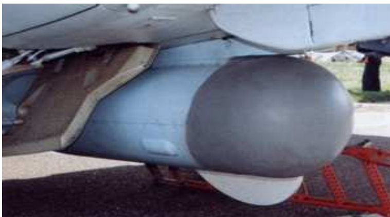
Kuva 16: Kopyo-25 tutkapodin prototyyppi asennettuna SU-25TM rynnäkkökoneeseen. [32]
