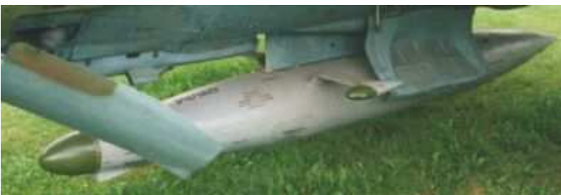
Kuva 22: SPS-141MVG-E häirintäjärjestelmän säiliö. [32]
