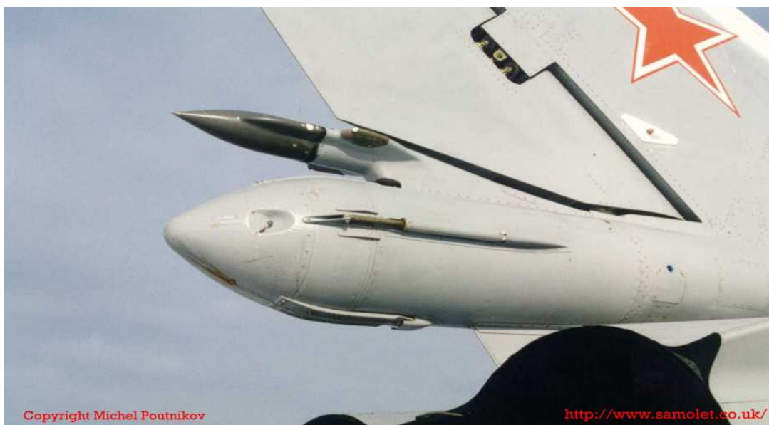
Kuva 12: SU-24 pyrstössä oleva SPO-15 tutkavaroittimen sensori. [10]
