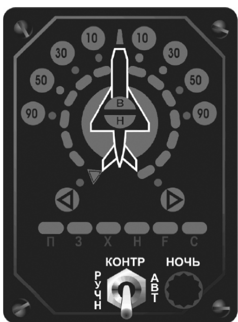
Kuva 11: SU-27 "Flanker" hävittäjässä käytetty SPO-15 tutkavaroittimen näyttö. [16]
