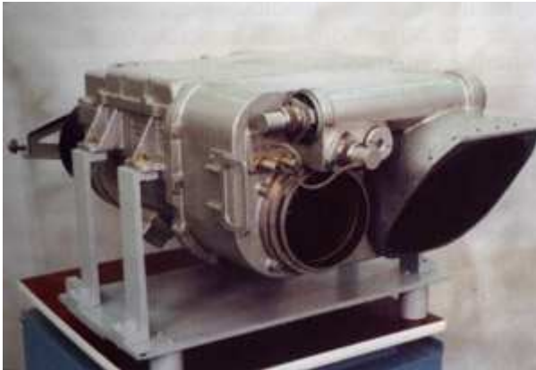
Kuva 20: Mercuri LLLTV -järjestelmän linssit laajalle ja kapealle näkökentälle. [32]
