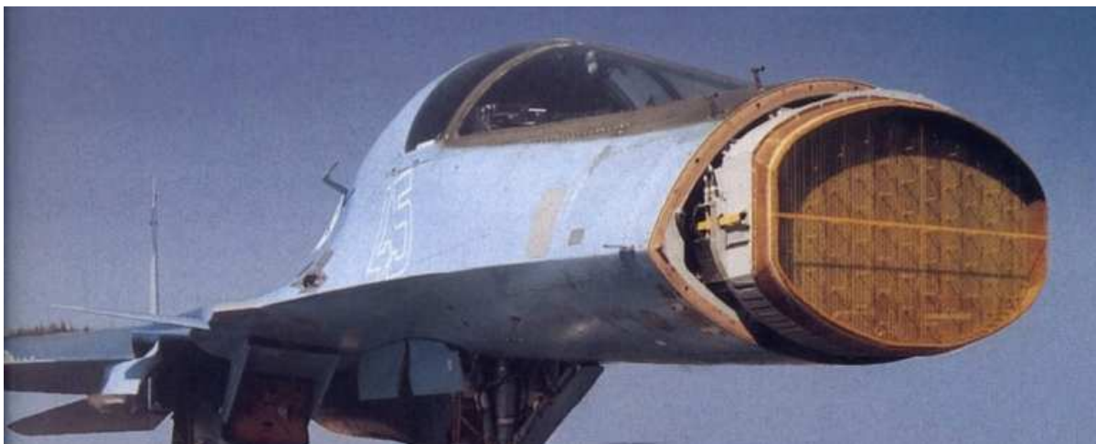
Kuva 27: SU-34 koneeseen kiinnitetty B-004 –tutkan prototyyppi. [46]
