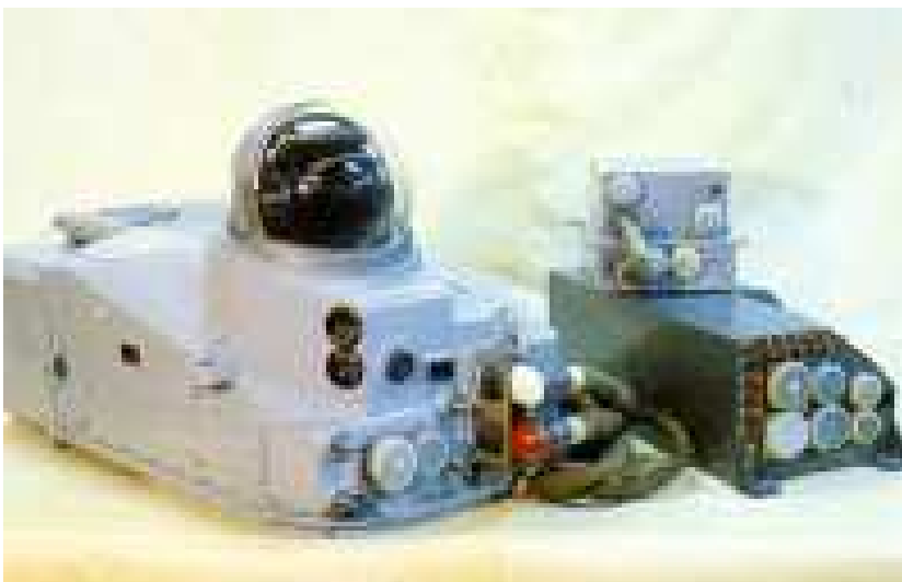
Kuva 34: MiG-29SMT IRST laitteisto. [9]
