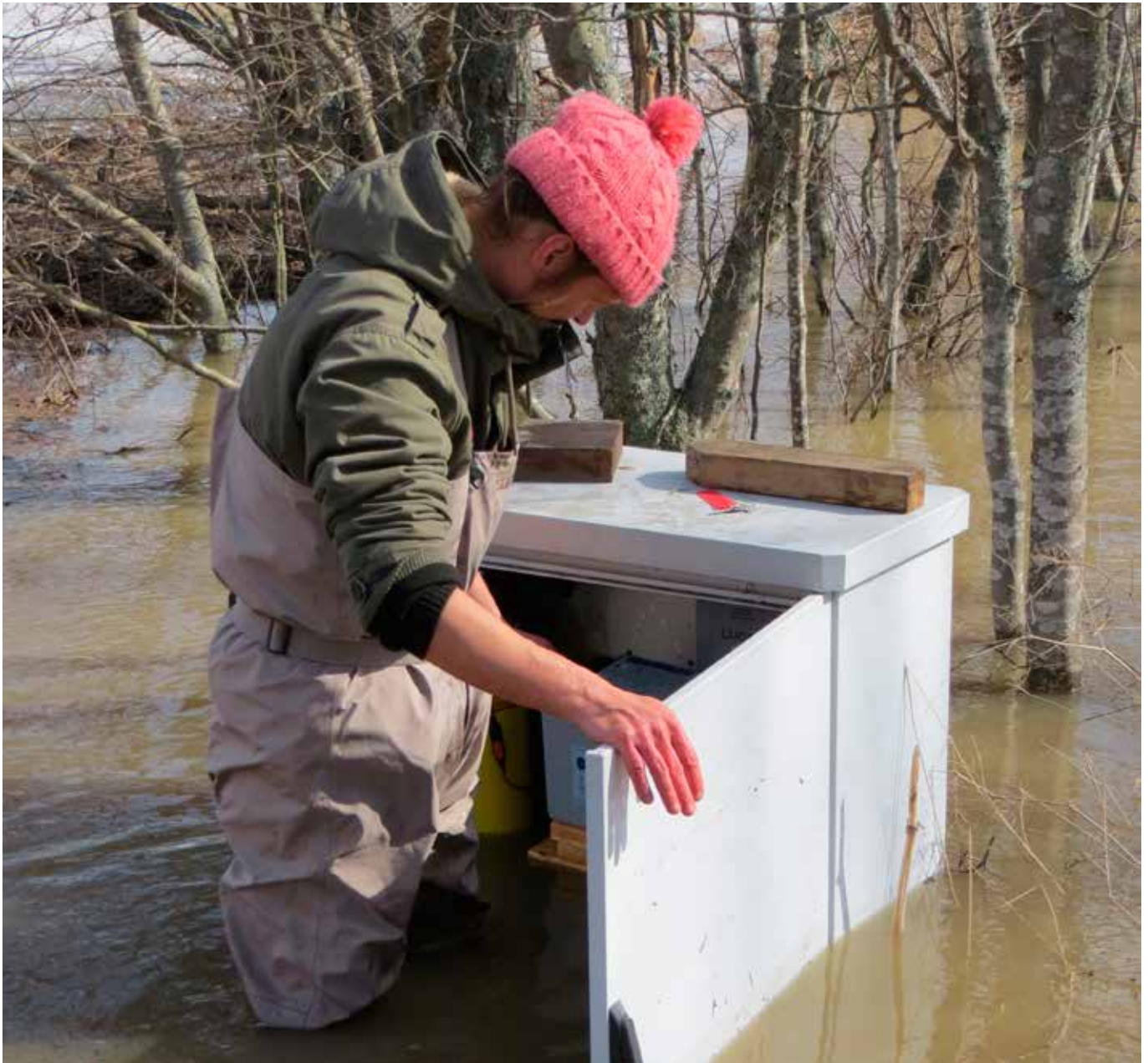
Kuva 14. Vedenlaadun automaattimittaus vaatii huoltotoimia myös ääriolosuhteissa. Kuva: Silva Wilander
