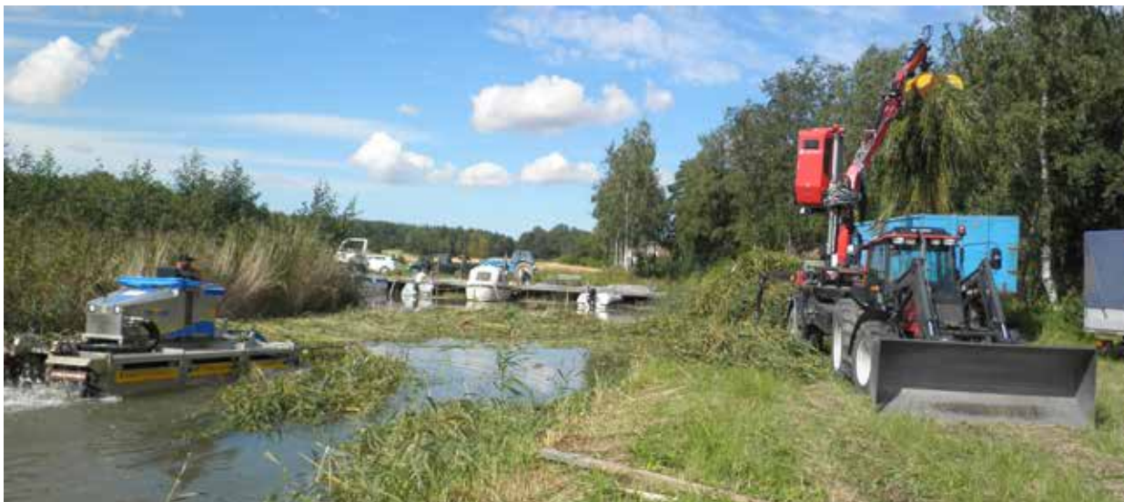
Vedestä leikattu ruokomassa on kuljetettava rantaan joko leikkuukoneen tai veneeseen kiinnitetyn haravan avulla. Poiskuljetettava massa voidaan lastata kuorma-autoon esim. juurikaskouran avulla. Lastauspaikan tulee olla riittävän laaja ja kovapohjainen kantakseen koneiden ja muun kaluston painon, ruokomassasta valuneesta vedestä vettyneenäkin.
