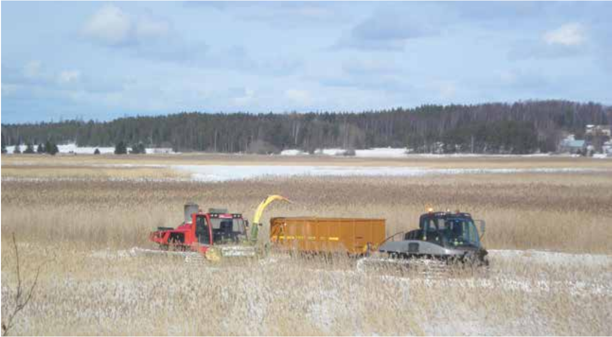
Kuvan laitteisto on mahdollista yhtäaikaista niiton ja niittojätteen poiskeruun (valmiiksi silputtuna ja esimerkiksi suoraan kompostoitavaksi soveltavana). Rinnekoneiden pienen pintapaineen omaava telaketjusto estää vakavat vauriot kosteilla ja pehmeäpohjaisilla rantaniityillä. Laitteita on käytetty myös rantaniittyjen kunnostukseen, äestämiseen ja murskaukseen – lisälaitteita vaihtamalla.
