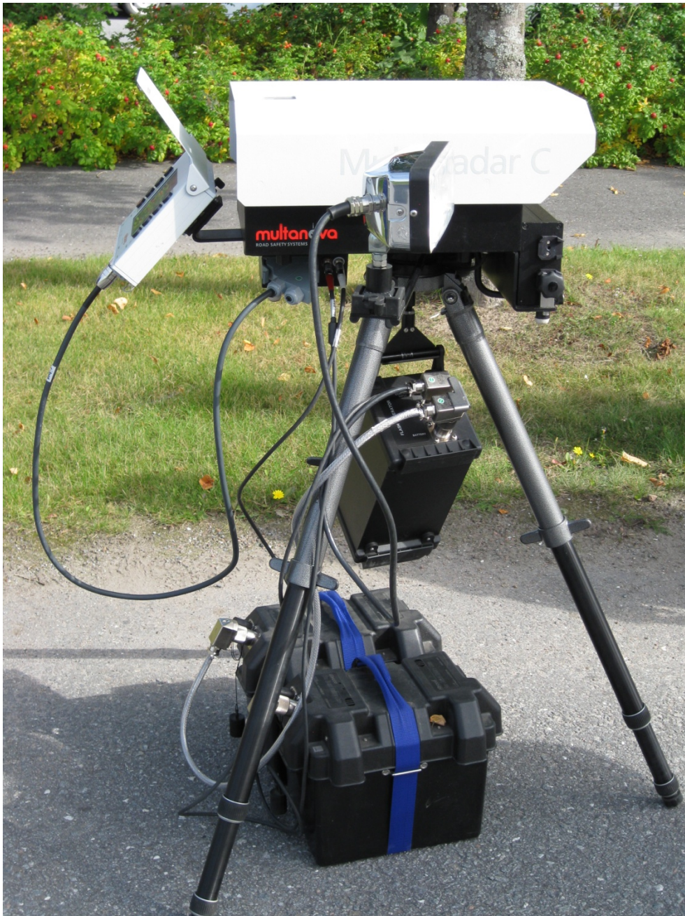
Bild 3. Med polisens trefotsutrustning kan man effektivt övervaka t.ex. omkörningsfilernas hastighetsnivå.
