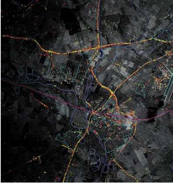
Kuva 3. Liikkuvia kohteita GMTI-moodissa esitettynä SAR-kuvan päällä [1].
