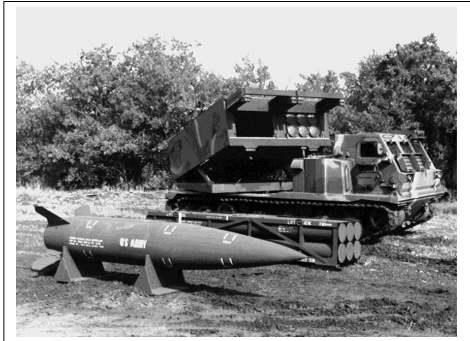
KUVA 4: Yhdysvaltalainen MLRS-raketinheitin M 993 tela-ajoneuvon alustalla. Maassa heittimen edessä normaali kuuden raketin rakettikasetti sekä yksi ATACMS -taktinen ohjus.
