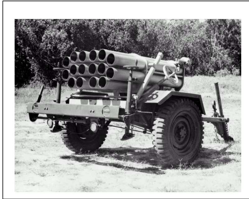
KUVA 1: Vedettävä brasilialaisvalmisteinen Avibras SBAT-70 -raketinheitin
