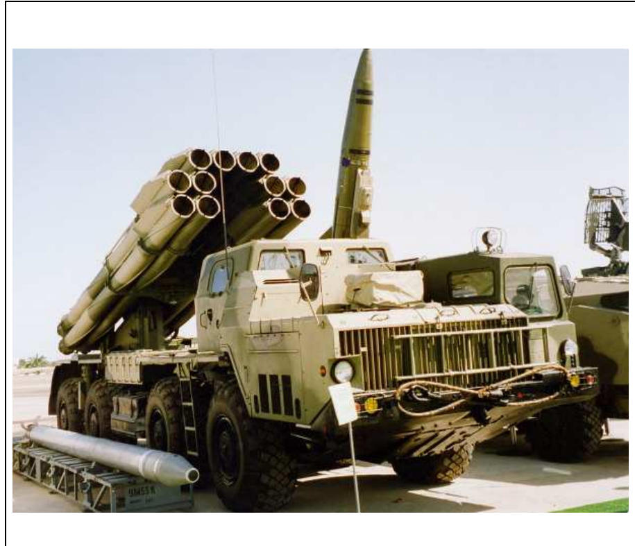
KUVA 3: Venäläinen 300 millimetrinen 9A52 Smerch -raketinheitin MAZ-543A -maastokuorma-autoalustalla.
