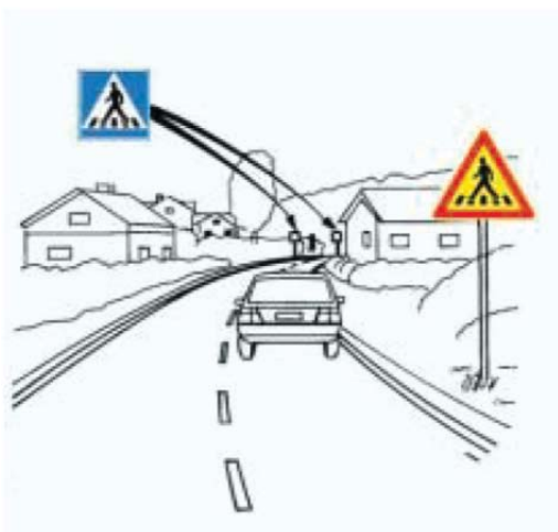
Kuva 20. Suojatien ennakkovaroitusmerkkiä käytetään kohteissa, joissa suojatie ei ole riittävän ajoissa kuljettajan havaittavissa.
