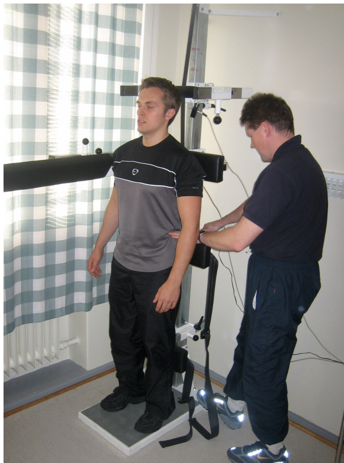
Kuvio 29. Testilaitteen säätö koehenkilölle sopivaksi.
