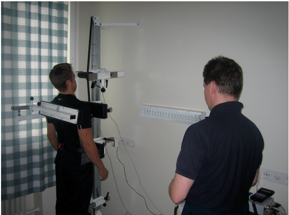
Kuvio 32. Vartalon ojentajien isometrisen maksimivoiman mittaus dynamometrillä.
