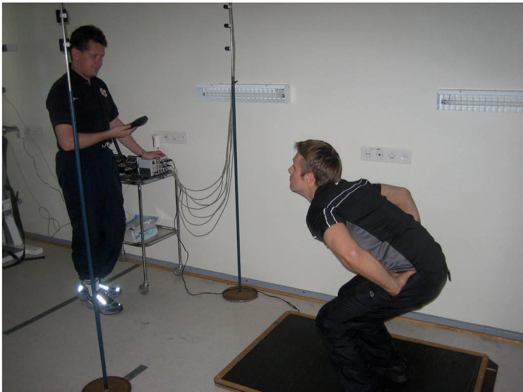
Kuvio 30. Anaerobisen tehon mittaus kontaktimatolla.
