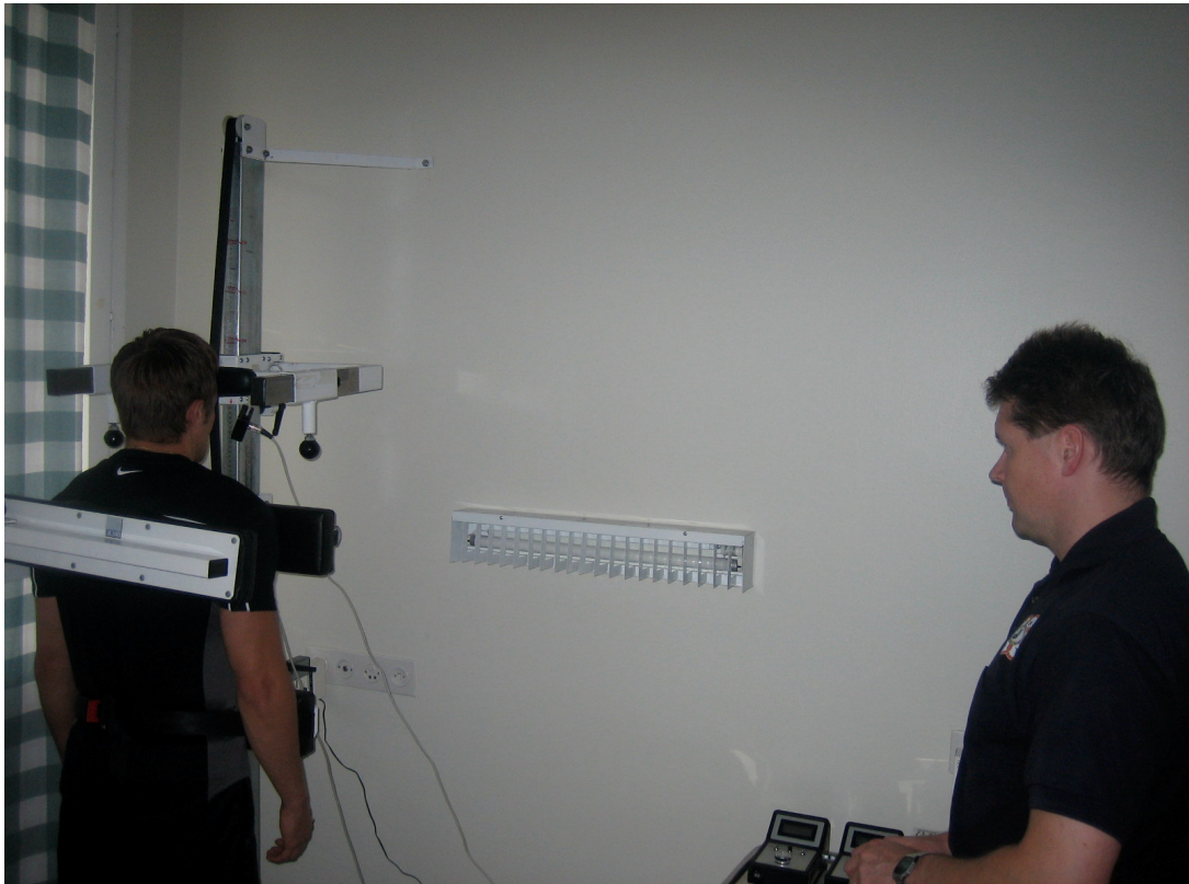
Kuvio 34. Pään koukistus eteenpäin. Kaulan isometrisen maksimivoiman mittaus dynamometrillä.
