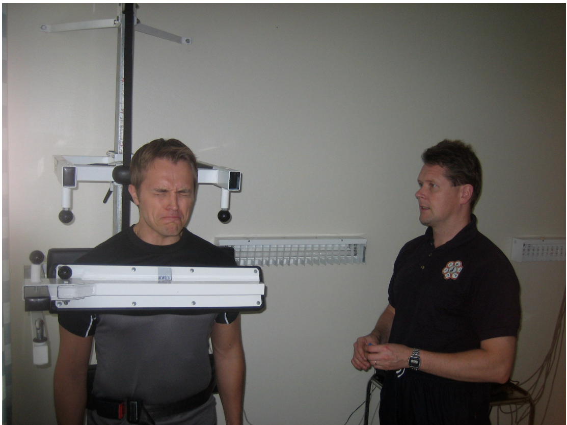
Kuvio 33. Pään ojennus taaksepäin. Niskan isometrisen maksimivoiman mittaus dynamometrillä.
