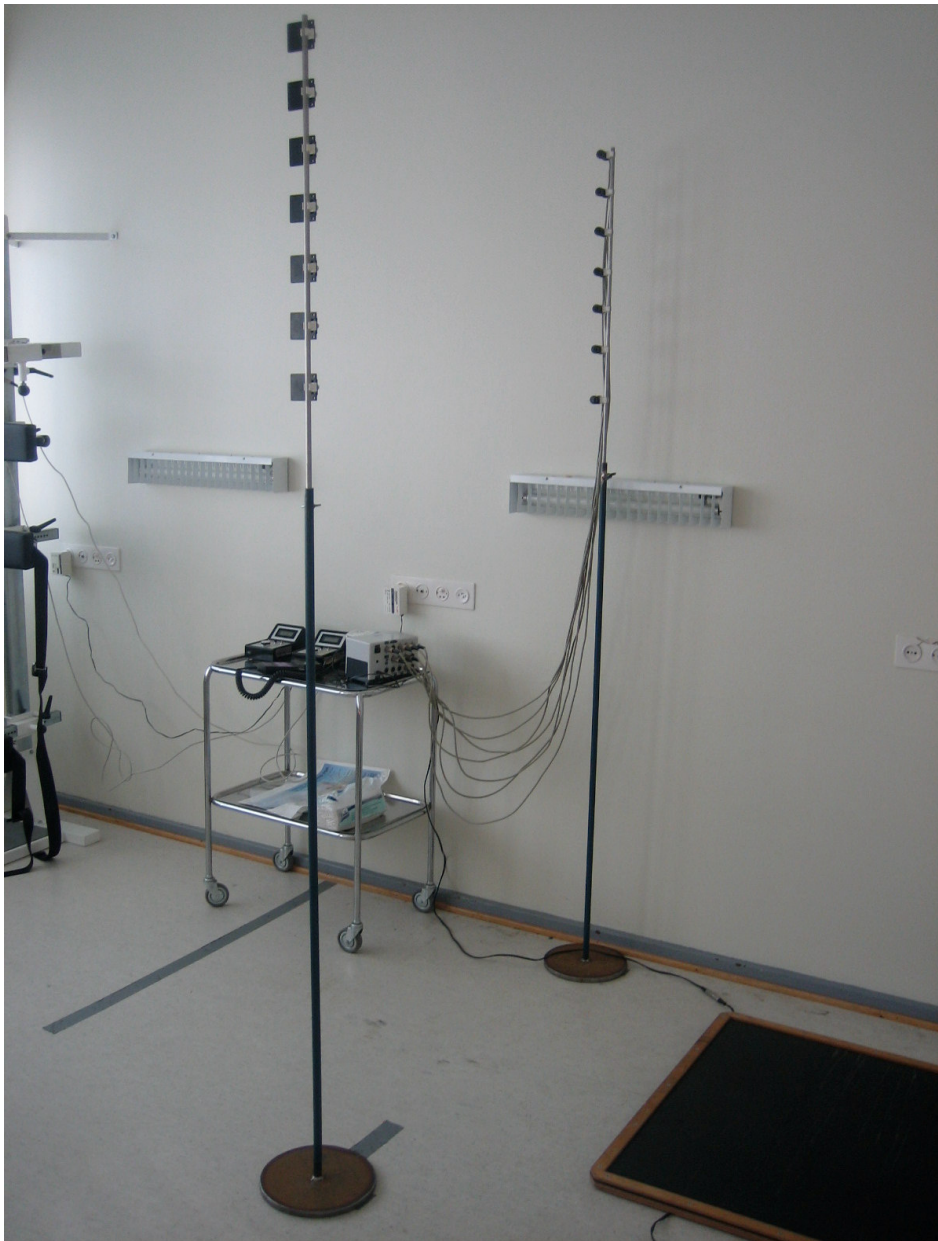
Kuvio 28. Newtest Oy:n valokennoportti, näyttölaite ja kontaktimatto (Tossavainen 2004).
