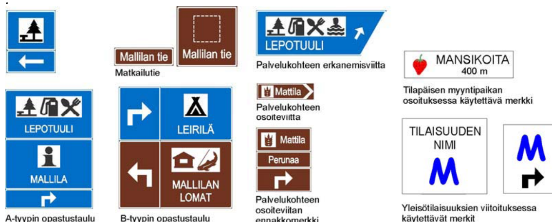
Kuva 1-2 Palvelukohteen viitoituksessa käytettävät liikennemerkkit.
