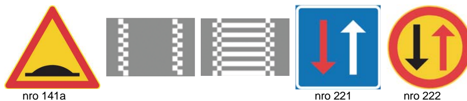
Kuva 39. Vasemmalta liikennemerkki töyssyjä (nro 141a), ruutumerkintä korotuksen kohdalla, ruutumerkintä korotetun suojiesten kohdalla, liikennemerkki etujajo-oikeus kohdatessa (nro 221) ja väistämisvelvollisuus kohdatessa (nro 222).
