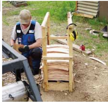
Päreitä valmistettiin alusta alkaen. Kaadetut puut kuorittiin ja pätkittiin sopivan mittaisiksi pölkkyiksi. Pölkkyt kasteltiin ennen päreiksi höyläämistä.
