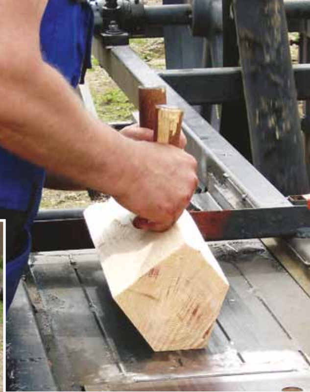
Päreitä valmistettiin alusta alkaen. Kaadetut puut kuorittiin ja pätkittiin sopivan mittaisiksi pölkkyiksi. Pölkkyt kasteltiin ennen päreiksi höyläämistä.
