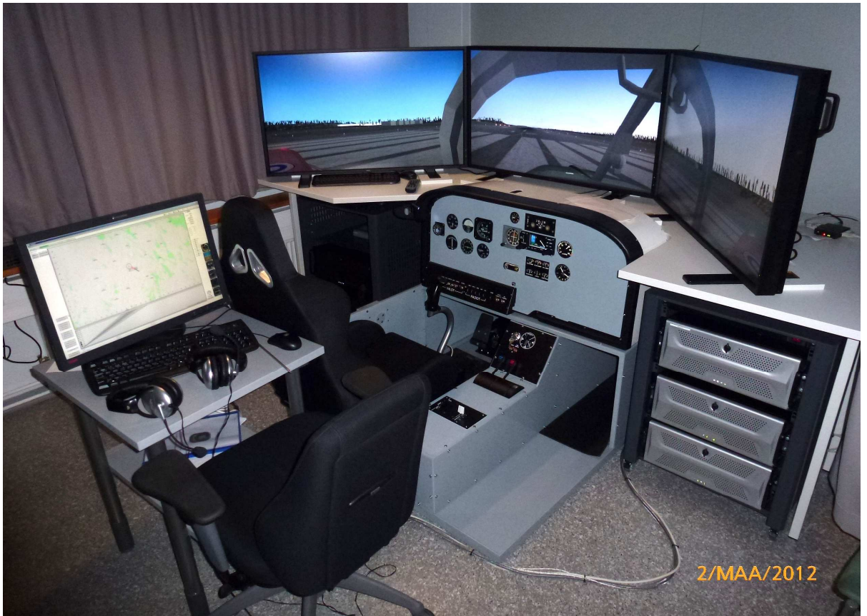
Kuva 2. Lentokoulutuksessa käytettävä Vinka-simulaattori, joka on varustettu uudella kolminäyttöisellä visuaalijärjestelmällä.
