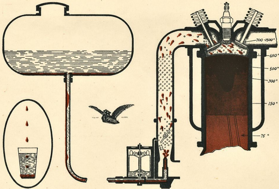
Vevhusoljning och bränslet tillsatt med motorolja. Kuv. 2. Veivikammiovoitelu ja polttoaineeseen sekoitettuna koneöljyä.
