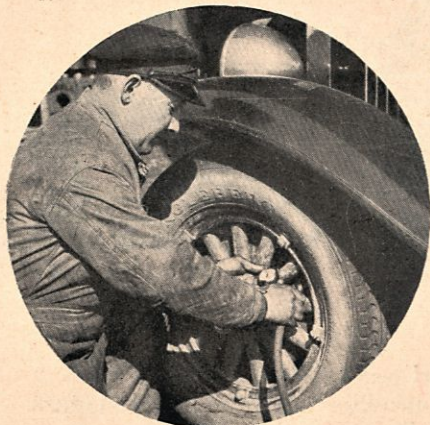
Kumit tarkastetaan huolellisesti, korjataan ja täytetään ilmalla määräysten mukaan.
