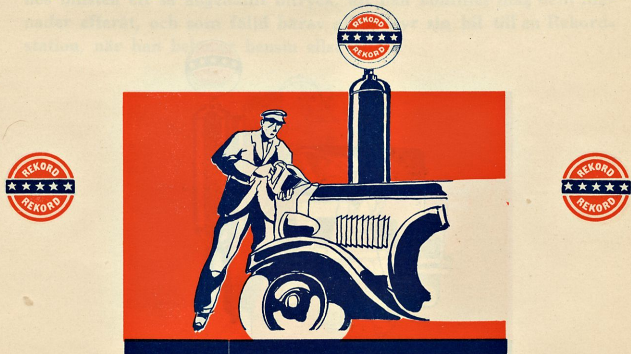
Vid påfyllning av kylvatten tillses att vattnet är rent och att det ej rinner över. Stänka dock droppar på kylaren avtorkas de noggrant.
