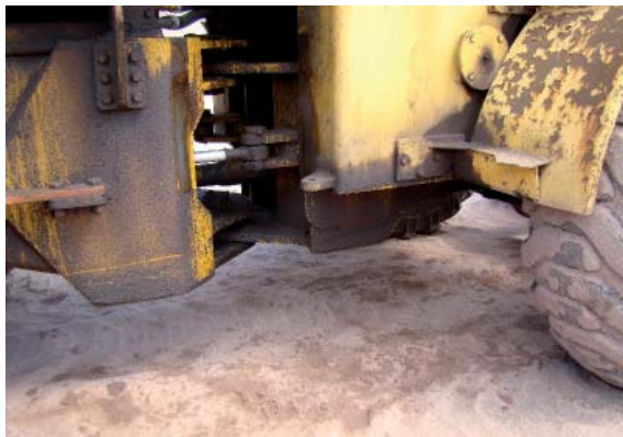
Kuopassa 17 on öljyä ja polttoainetta vuotava kauhakuormaaja.
