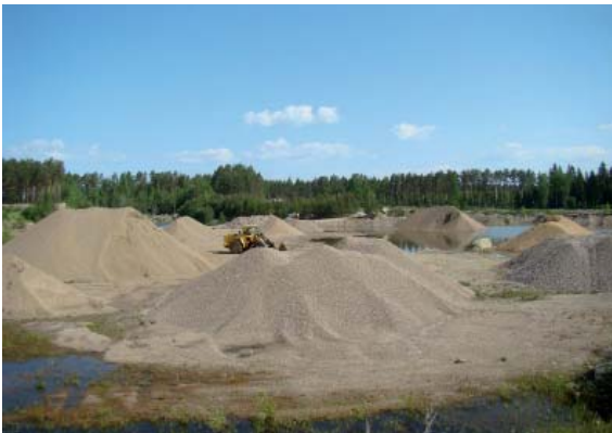
Nummenharjun alueelta on maa-ainesten ottoa pohjaveden pinnan alapuolelta.
