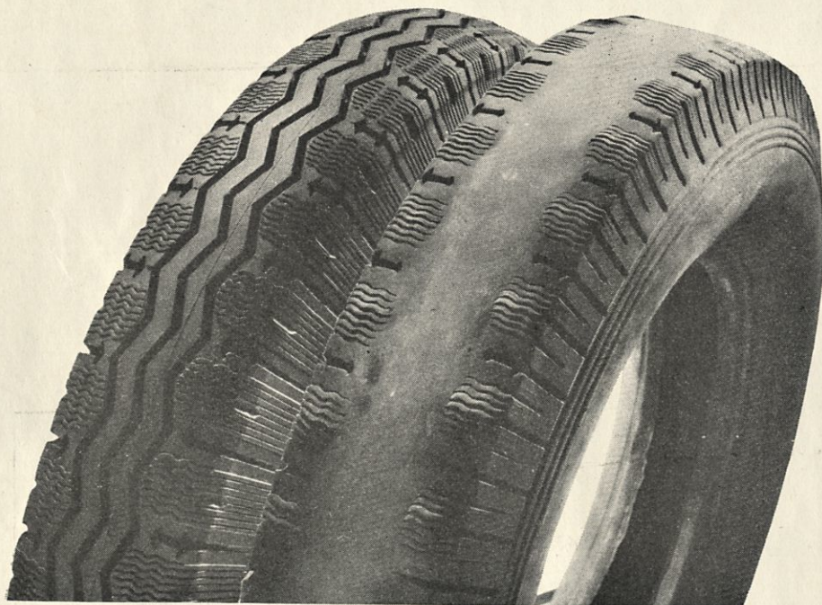
Kuva 3. Uusi ja sen vieressä melkein loppuunkäytetty Stop-rengas. — Vaikka kulutuspinnan keskiosa on jo melkein kokonaan kulunut, erikoislamellit jatkavat edelleenkin työtään.
