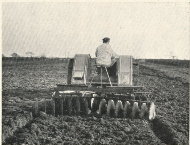
Tallriksharvarna arbeta fint och avverkningsbredden är betydande, då Fordson är spänd för dem.
