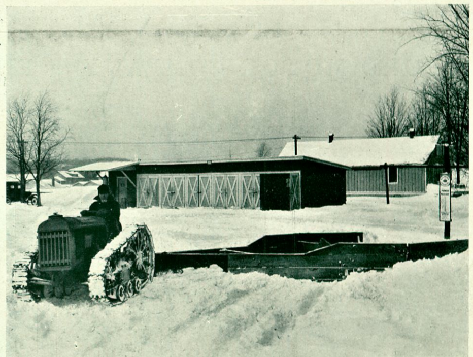
Fordson kan också draga en vanlig snöplog.
