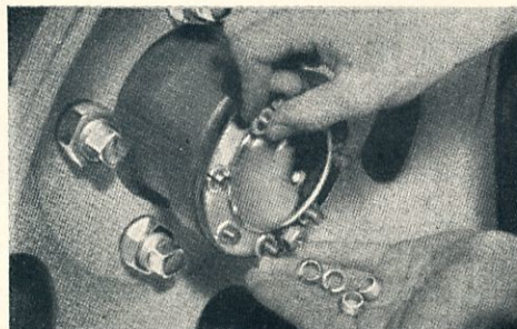
Koniska ringar på bakaxels pinnbultar hindra slitage i hålen och hålla flänsen väl ansatt.
