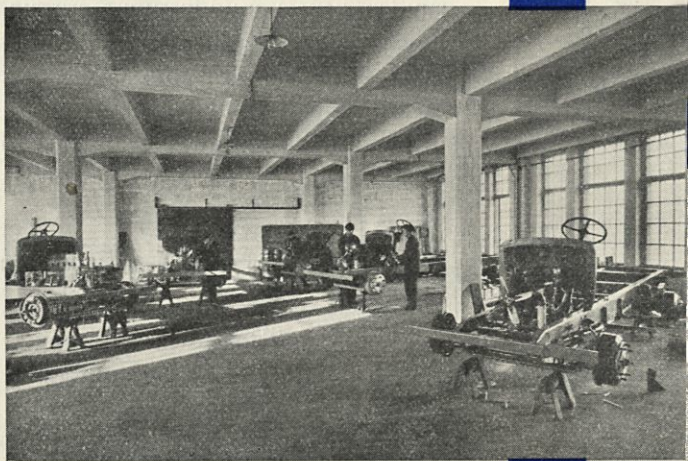
Täällä kootaan Sisun osat huolellisesti tarkastaen luotettaviksi kuorma- ja linja-auton konealustoiksi.
