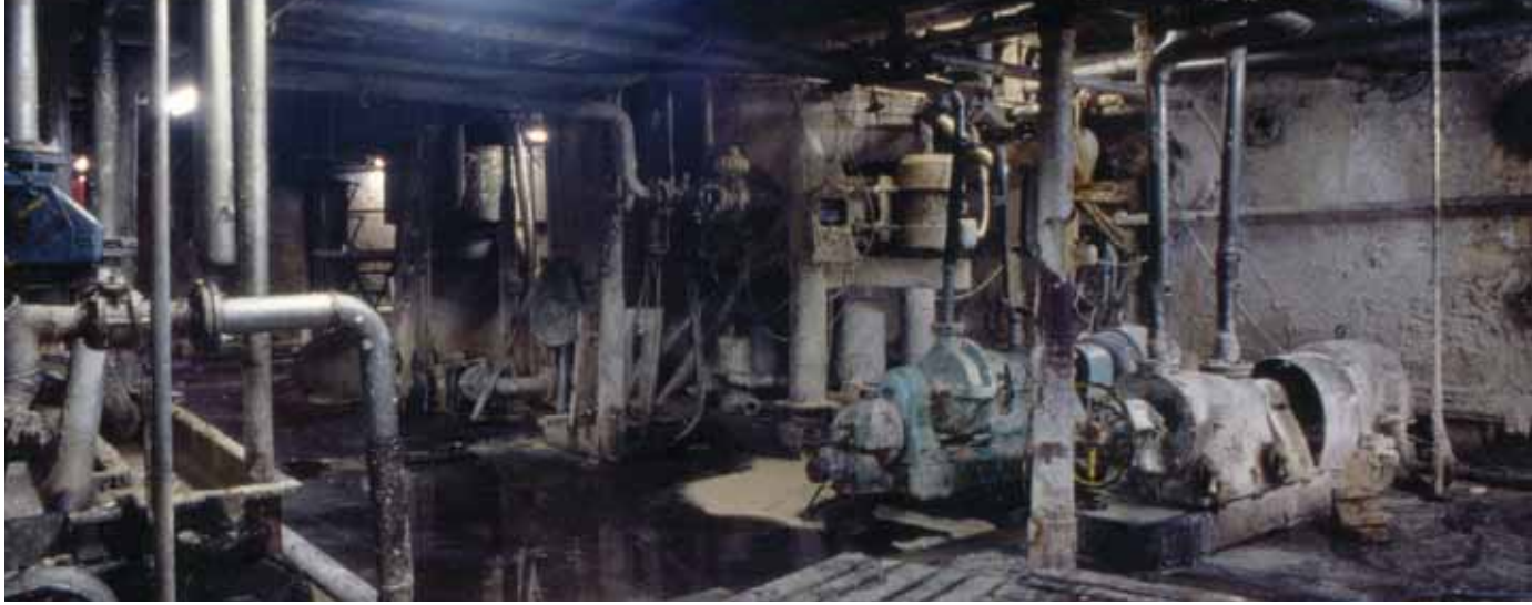
Kuva 19: Hollanderihuone. Oikealla ovat massajauhinten käyttömoottorit. Matti Huuhka 1998, Museokuva, MV.
