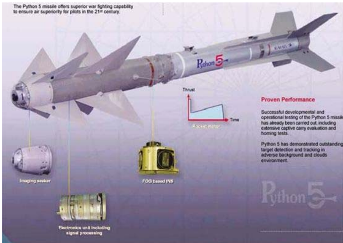
Kuva 26: Python 5-ohjuksessa on suuri määrä siivekkeitä, eikä lainkaan suihkusuuntausta [25]
