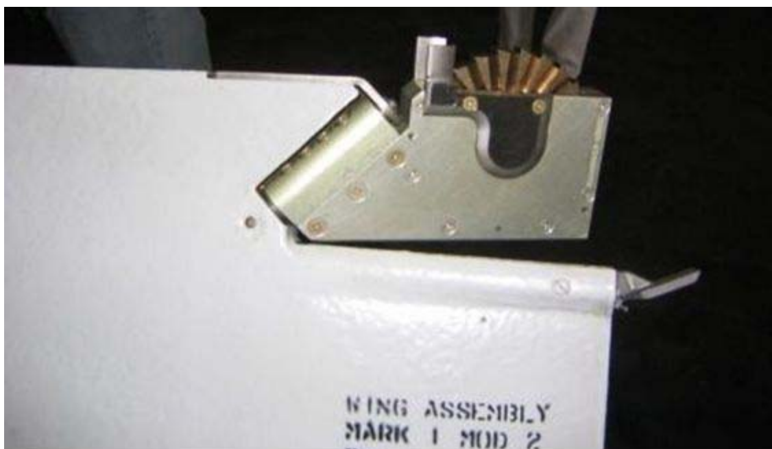
Kuva 9: AIM-9M-ohjuksessa olevat rolleronit vakauttavat ohjuksen lentoa
