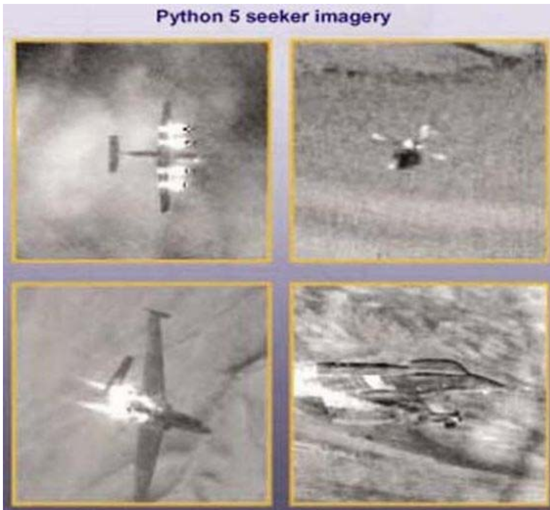
Kuva 25: Python 5-ohjuksen hakupää on kuvanmuodostuskykyinen [25]
