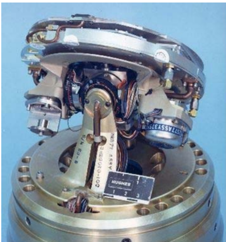
Kuva 29: AIM-120A AMRAAM-ohjuksen hakupää [14]
