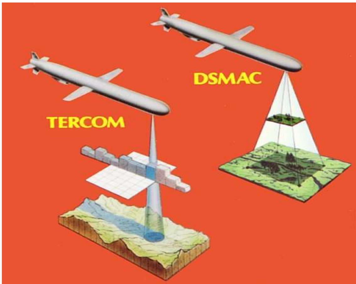
Kuva 7. TERCOM- ja DSMAC- navigointijärjestelmät. 73
