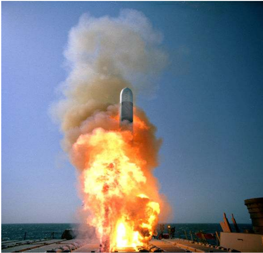
Kuva 5. Tomahawk- risteilyohjus laukaistaan VLS- kennosta.
