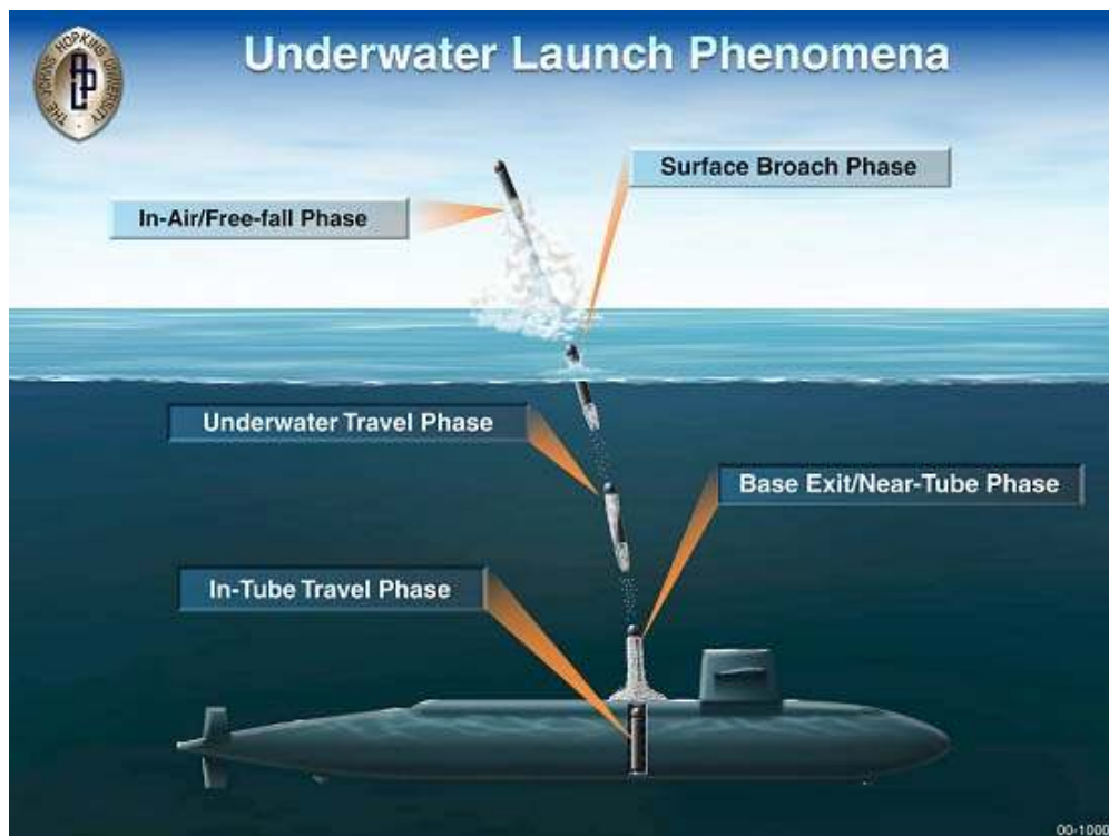
Kuva 2. Vedenalaisen laukaisun vaiheet.
