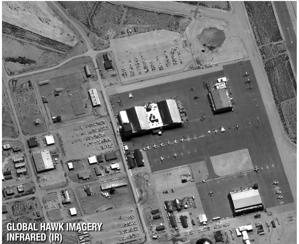
Kuva 1. Global Hawkin lämpökameran kuvaa Edwards´n lentotukikohdasta. Kuva on otettu 17 680 metrin korkeudesta. Kuvasta on huomattavissa lähteneiden koneiden varjojen lämpöerot asfaltissa. Lentokoneiden tunnistaminen on mahdollista.
