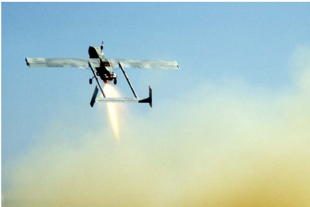
Kuva 4. RQ-2 Pioneer nousussa rakettilaukaisun avulla. 53
