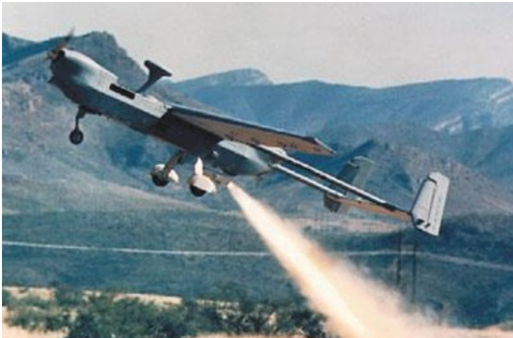
Kuva 6. RQ-5 Hunter nousussa rakettilaukaisun avulla. 70
