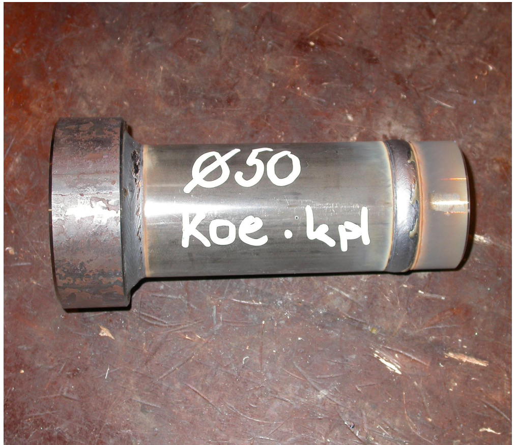
Kuva 28. Koekappale NS50, joka on hitsattu Nastolan tehtaassa
