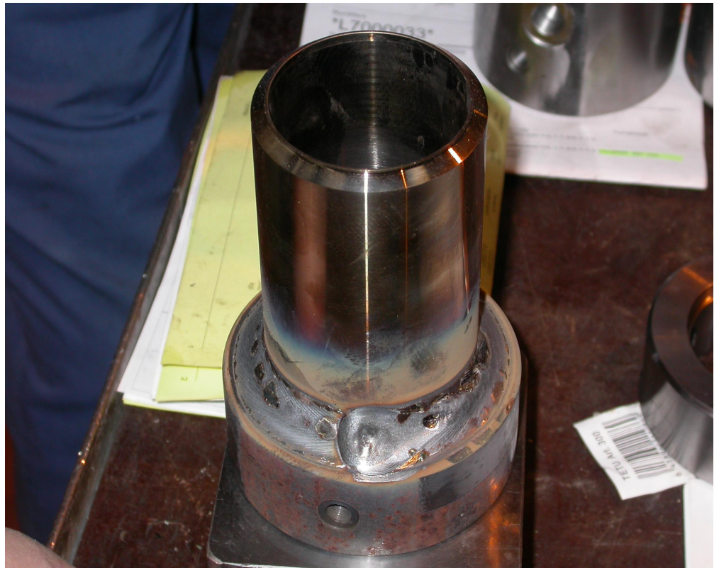
Kuva 23. Sylinterin etupään hitsaus sylinteriputkeen, jossa on selvästi havaittavissa lopetusvirhe
