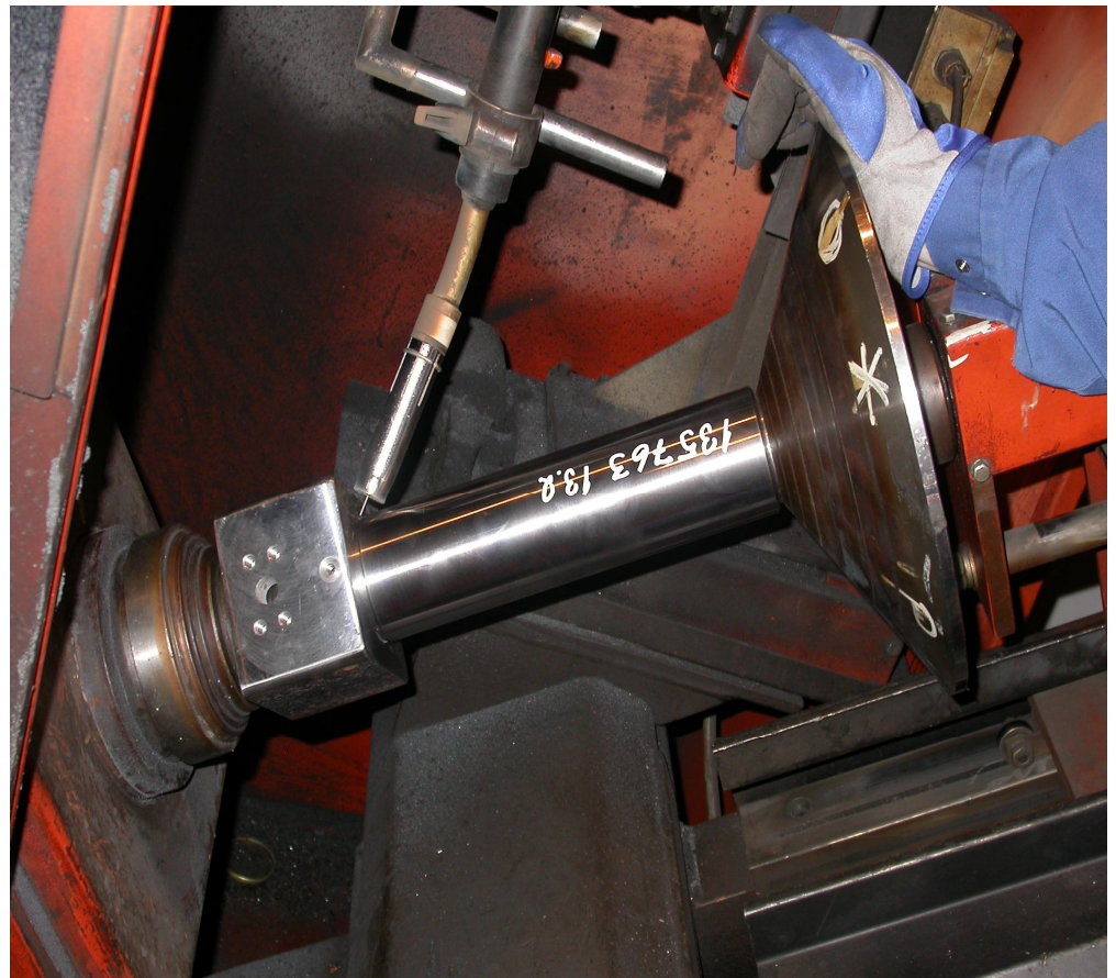
Kuva 15. Sylinteriputken hitsaus pyörityslaitteilla Nastolaan tehtaassa
