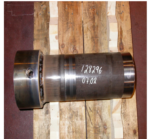
Kuva 2. Sylinteriputken takapään hitsaus
