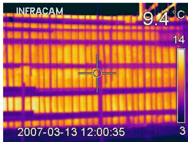
Kuva 20. VSS:n seinämuotti on täyttynyt tasaisesti betonilla
