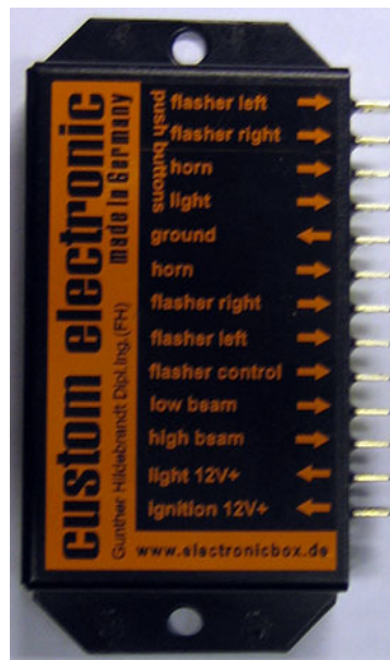
Kuva 11. Silver Bulletin releohjain. Releohjaimen kanteet on piirretty nuolet kuvaamaan sisään- ja ulostuloja kytkentöjen helpottamiseksi.
