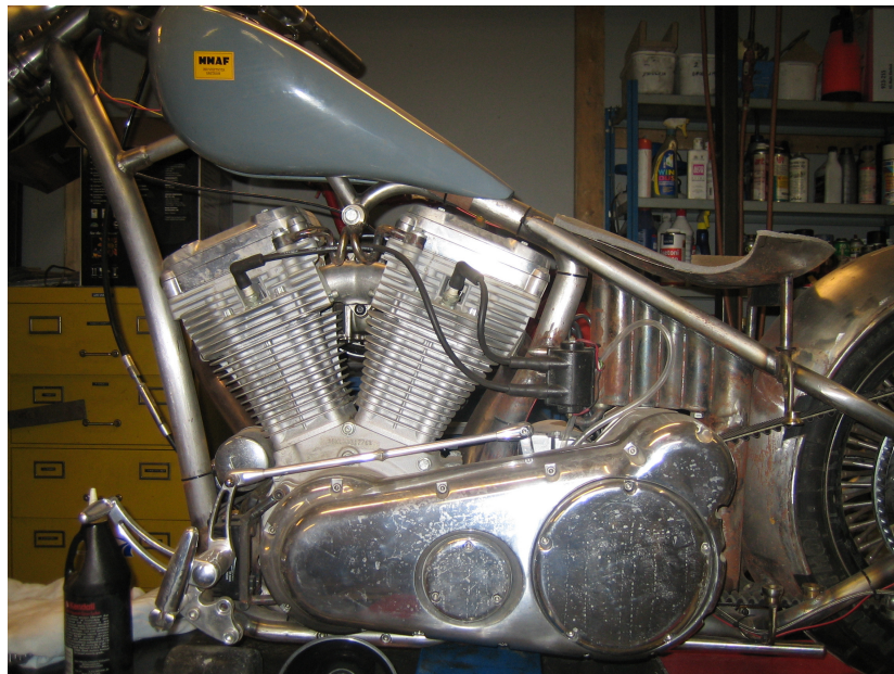
Kuva 7. Kuvassa näkyy HD:n Evolution -moottori. Moottorin sytytysjärjestelmä on myös hyvin esillä. Sytytysjärjestelmä on suurin häiriölähde testiä ajatellen.
