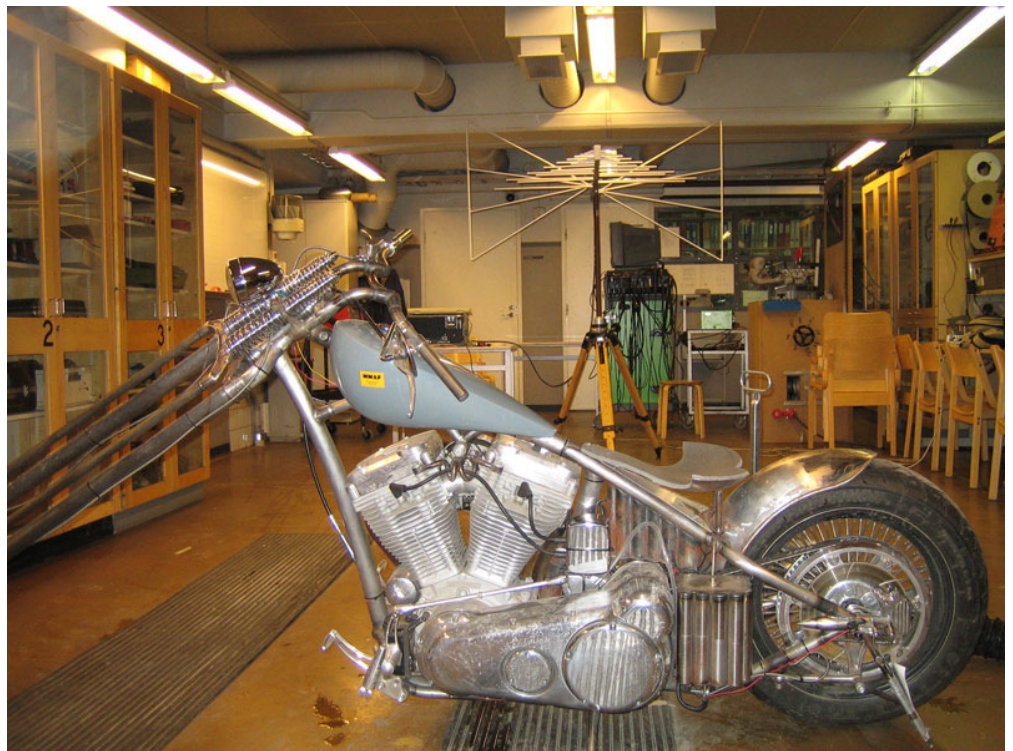
Kuva 6. Kuvassa näkyy hyvin mittaustila. Huomattavaa tilasta on antennin ja pyörän sijoitus sekä kuvan 2 vaatimuksiin sopiva huonekoko. Tila vaikuttaa selvästi antennin korkeusvaatimuksiin.
