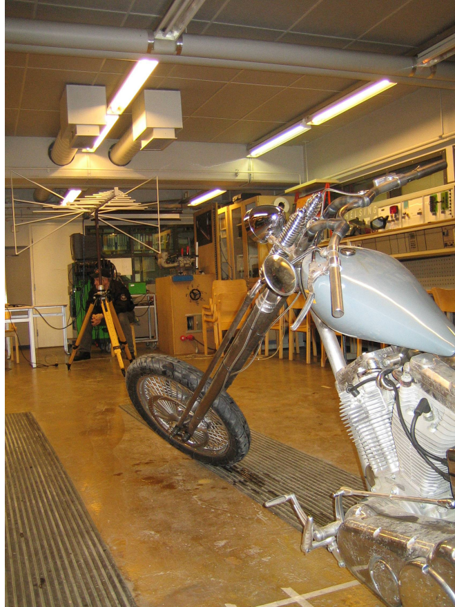
Kuva 22. Silver Bullet laajakaistaisten häiriöiden mittauksessa D
