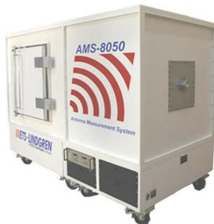
Kuva 20. ETS-Lindgren AMS-8050 siirrettävä, heijastukseton ”kontti” [27]
