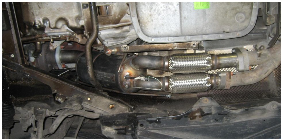
Kuva 6. BMW:hen asennettu hiukkassuodatin
