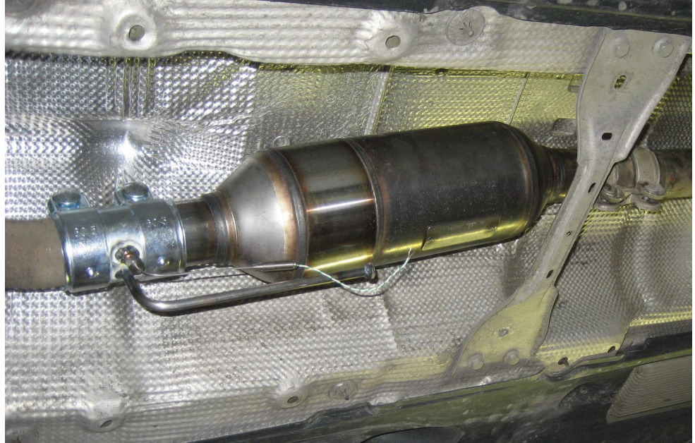
Kuva 7. Passatin hiukkassuodatin asennettuna
