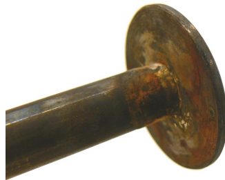
Kuva 32. Tutkittavan teräsputken toiseen päähän on juotettu kiinni metallilevy, josta mitatetaan putken lämpölaajeneminen mittakellolla.
