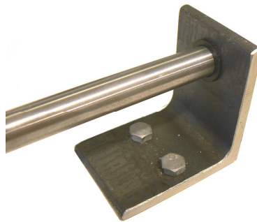
Kuva 30. Tutkittavan teräsputken toinen pää, joka on kiinnitetty tiivisteellä kiinteästi päätytukeen.
