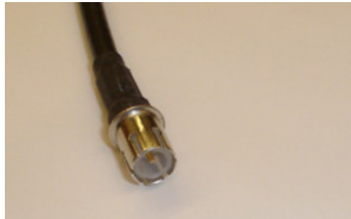
Kuva 47. Lopulliseen ratkaisuun valittiin kierteetön koaksiaaliliitin
