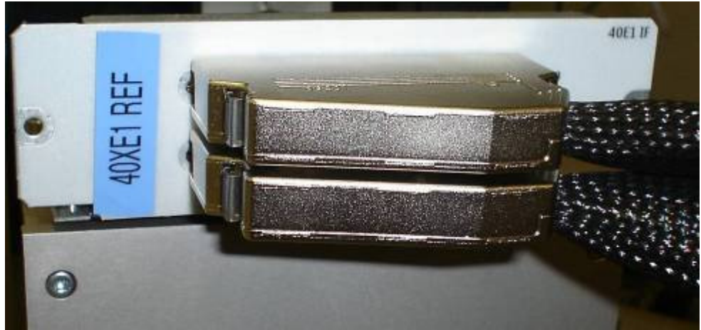
Kuva 38. Kuvassa 40E1 IF PIUhun on kytketty MDR80-kaapelit. PIUssa oleva sininen tarra kertoo, että kortti on ns. Golden Unit
