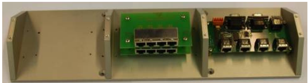
Kuva 40. Adapteritelineessä on vain kolme paikkaa, joista laitimaiset on varattu Main unitille ja 40E1 PIUlle
