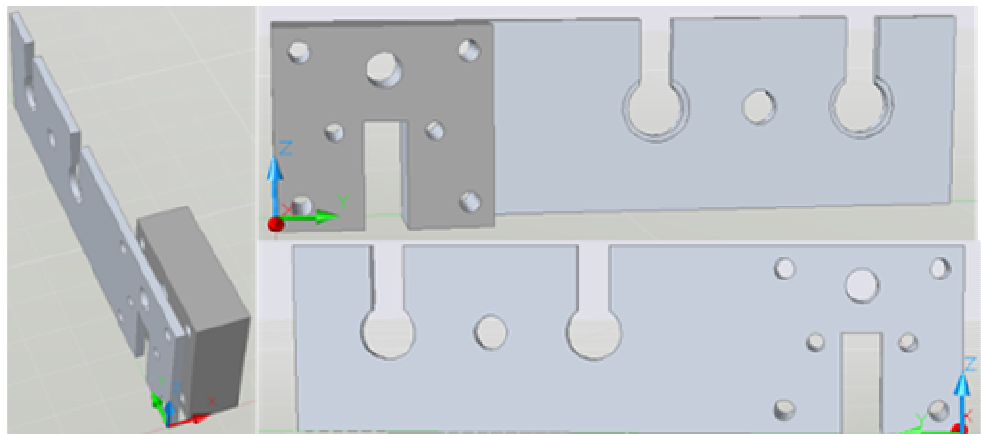
Kuva 64. Kuvat kaapelipidikkeen 3D-mallinuksesta ylhäältä, edestä ja takaa
