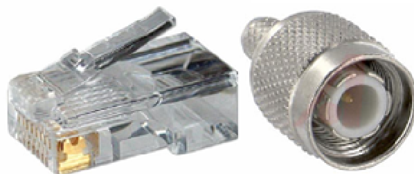
Kuva 46. Main unitissa käytetään RJ45- ja TNC-liittimiä
