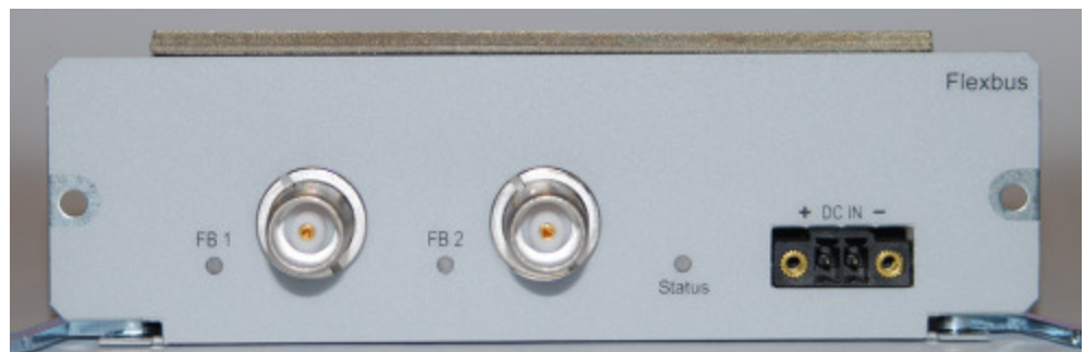
Kuva 19. Flexbus PIUn koaksiaaliliitännät voidaan yhdistää edellisen sukupolven FlexiHopper-radioihin
