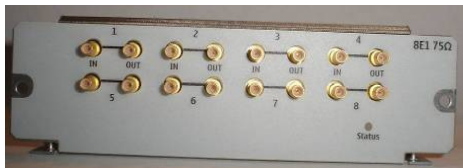
Kuva 14. 8E1 75 ohmin PIUssa on käytetty kullattuja liittimiä
