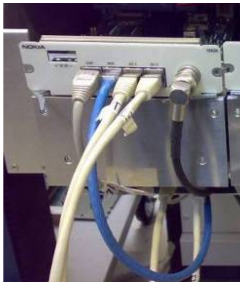
Kuva 34. Osa Main unitista lähtevistä kaapeleista viedään adapterille ja osa kaapelisimulaattorille
