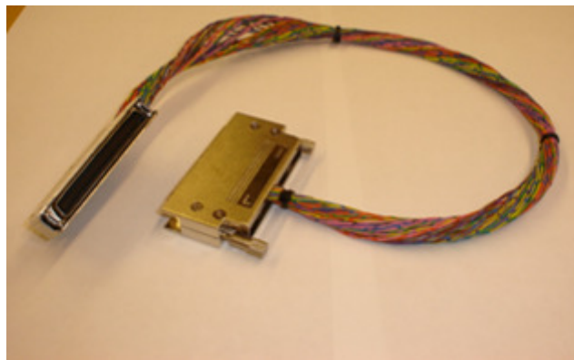
Kuva 53. Kaapeli vaipan poistamisen jälkeen
