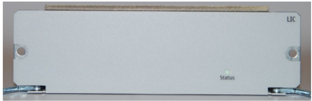
Kuva 18. LIC PIUssa ei ole lainkaan etupaneeliliitäntöjä
